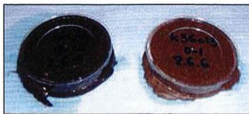
Figure 2. 15 : Echantillons dédiés à l'extraction de la fraction potentiellement disponible des métaux dans les sédiments. A gauche : échantillon de profondeur. A droite : échantillon de surface. La différence de coloration est nette et témoigne des conditions oxydée (en surface) et réduite (en profondeur) du milieu.
