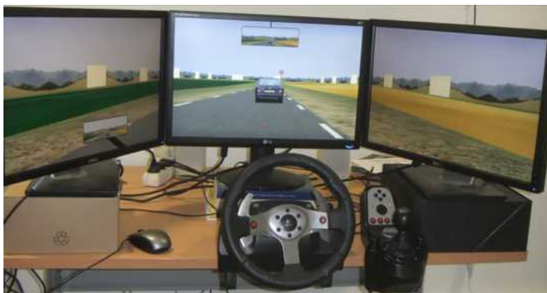
Figure 3.2 – Dispositif du simulateur de conduite (avec 3 écrans, volant, boîte de vitesse et pédalier) utilisant le simulateur de trafic routier ARCHISIM .
