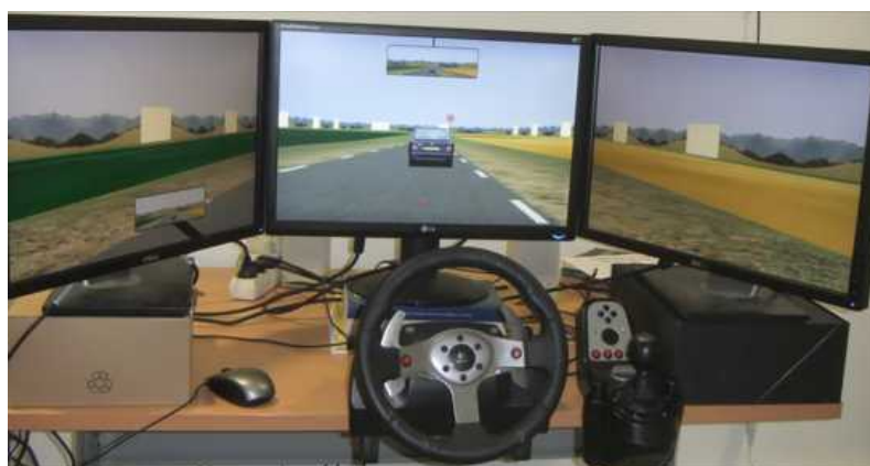
Figure 8.2 – Dispositif du simulateur de conduite (avec 3 écrans, volant, boîte de vitesses et pédalier) utilisant le simulateur de trafic routier ARCHISIM.
