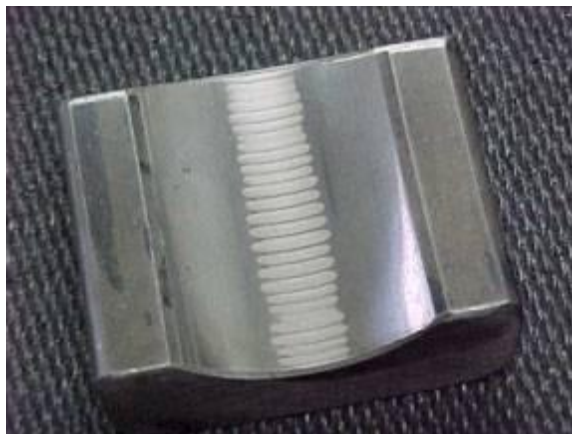
Figure 1 : Stries dues aux courants de palier sur une bague
