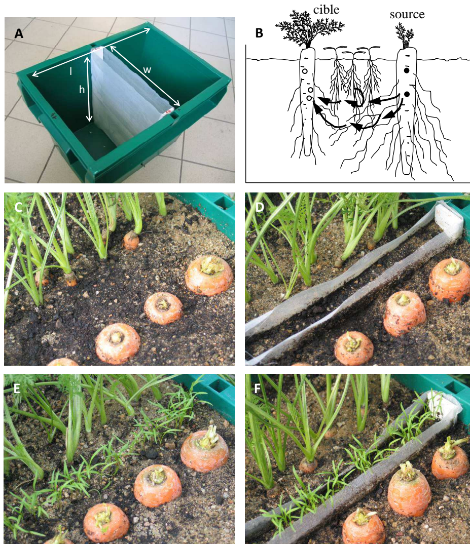
Figure 11 - Dispositif expérimental de type "rhizobox" (A) permettant d'étudier l'effet des racelles sur les allo-infections (B). Des racines de carotte "sources", préalablement inoculées avec P. violae , ont été transplantées en face d'une rangée de carottes "cibles" issues de semis. Les différents traitements, comparés à des témoins (C), ont consisté à séparer les deux rangées d'une double barrière de nylon laissant passer les zoospores et le mycélium mais pas les racelles (D), à obtenir entre les deux rangées un peuplement dense de très jeunes carottes (racelles supposées avoir un effet comparable à celui de racines adventives ; E), et à combiner les deux (F ; d'après Suffert & Lucas, 2008).
