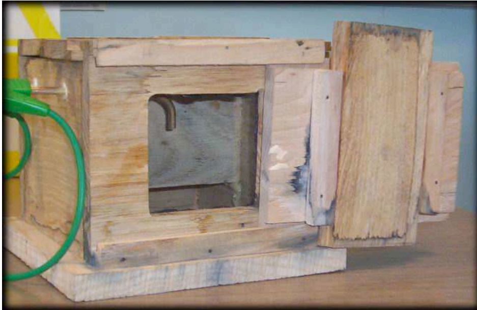
Fig 6 : 1 ière cuve de l'actinomètre, premier volet coulissant, et lucarne
