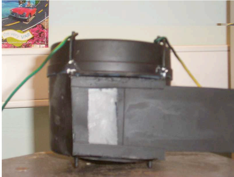
Fig 9 : 2 ème cuve de l'actinomètre en plexiglas et verre, volet coulissant
