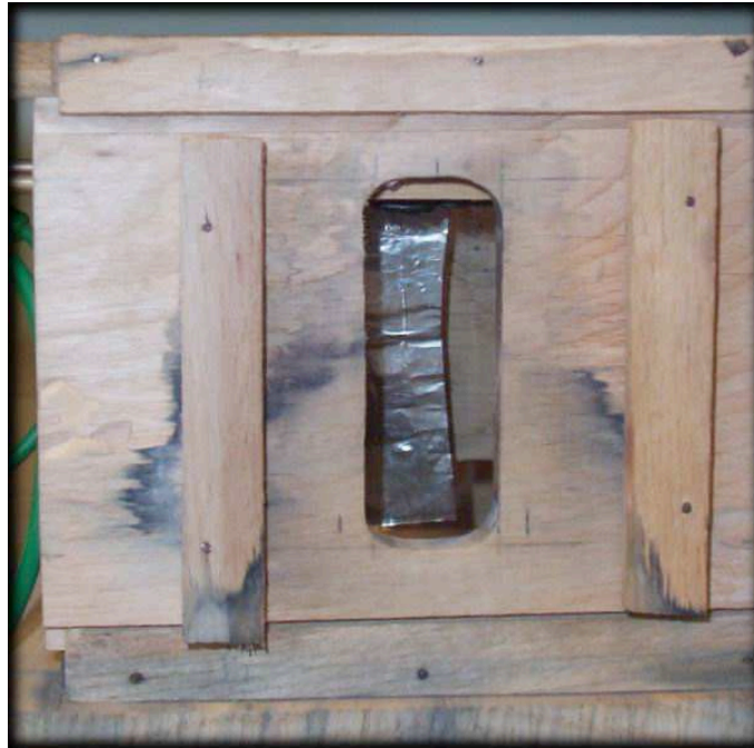
Fig 8 : 1 ière cuve de l'actinomètre, plaque fixée destinée à recevoir la lumière
