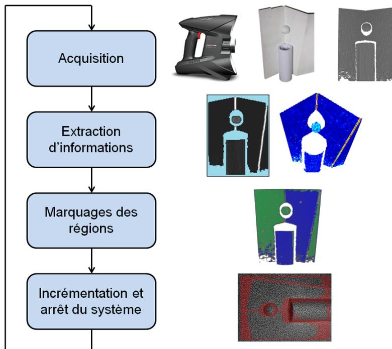
FIGURE 6.1 – schéma du système de numérisation dynamique.
