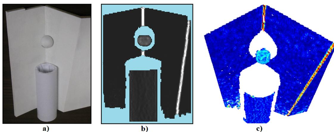
FIGURE 3.12 – *Calcul des coefficients de discontinuité. a) Objet test. b) Coefficients de discontinuité calculés pour chaque point image (la zone en bleu représente les points n'ayant pas de coefficients de discontinuité). c) Résultats plaqués sur le nuage de points en fausses couleurs pour un meilleur rendu visuel.*
