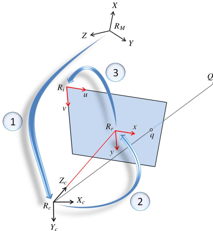
FIGURE 2.4 – Modélisation d'une caméra : modèle sténopé.
