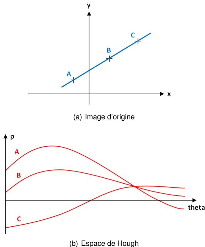
FIGURE 2.15 – Principe de la transformée de Hough. A chaque point  $A, B$  et  $C$  correspond une sinusoïde dans l'espace de Hough. Si les sinusoïdes se croisent en un point, il existe alors une droite qui passe par les trois points  $A, B$  et  $C$  dont l'orientation correspond à l'intersection des sinusoïdes dans l'espace de Hough.
