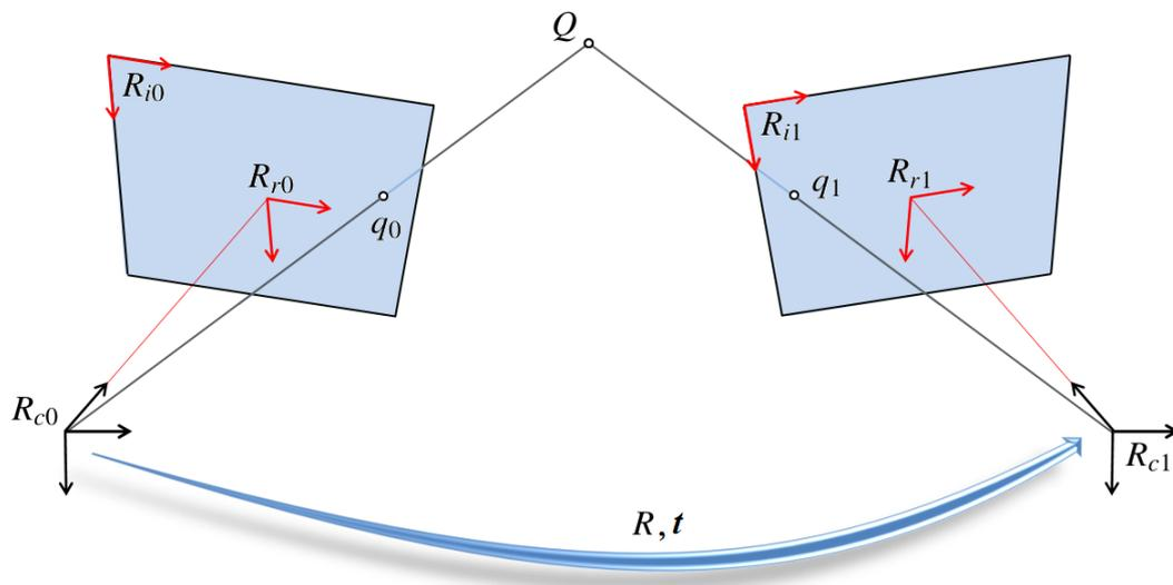
FIGURE 2.5 – Modélisation d'un système de stéréovision.
