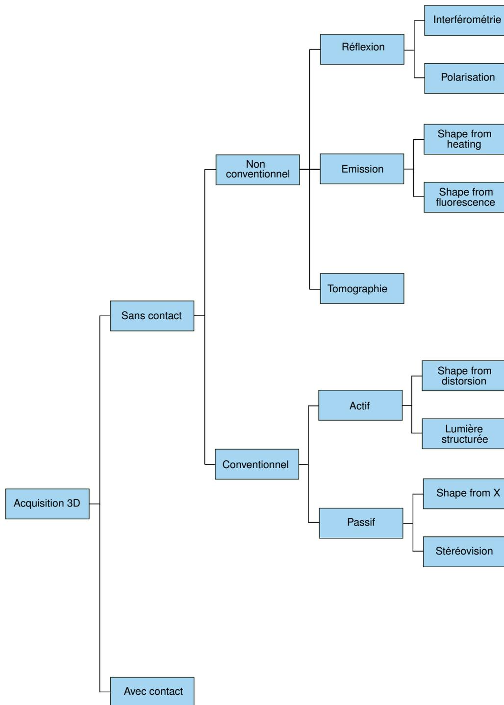
FIGURE 2.1 – Graphe non exhaustif des systèmes d'acquisition 3D.
