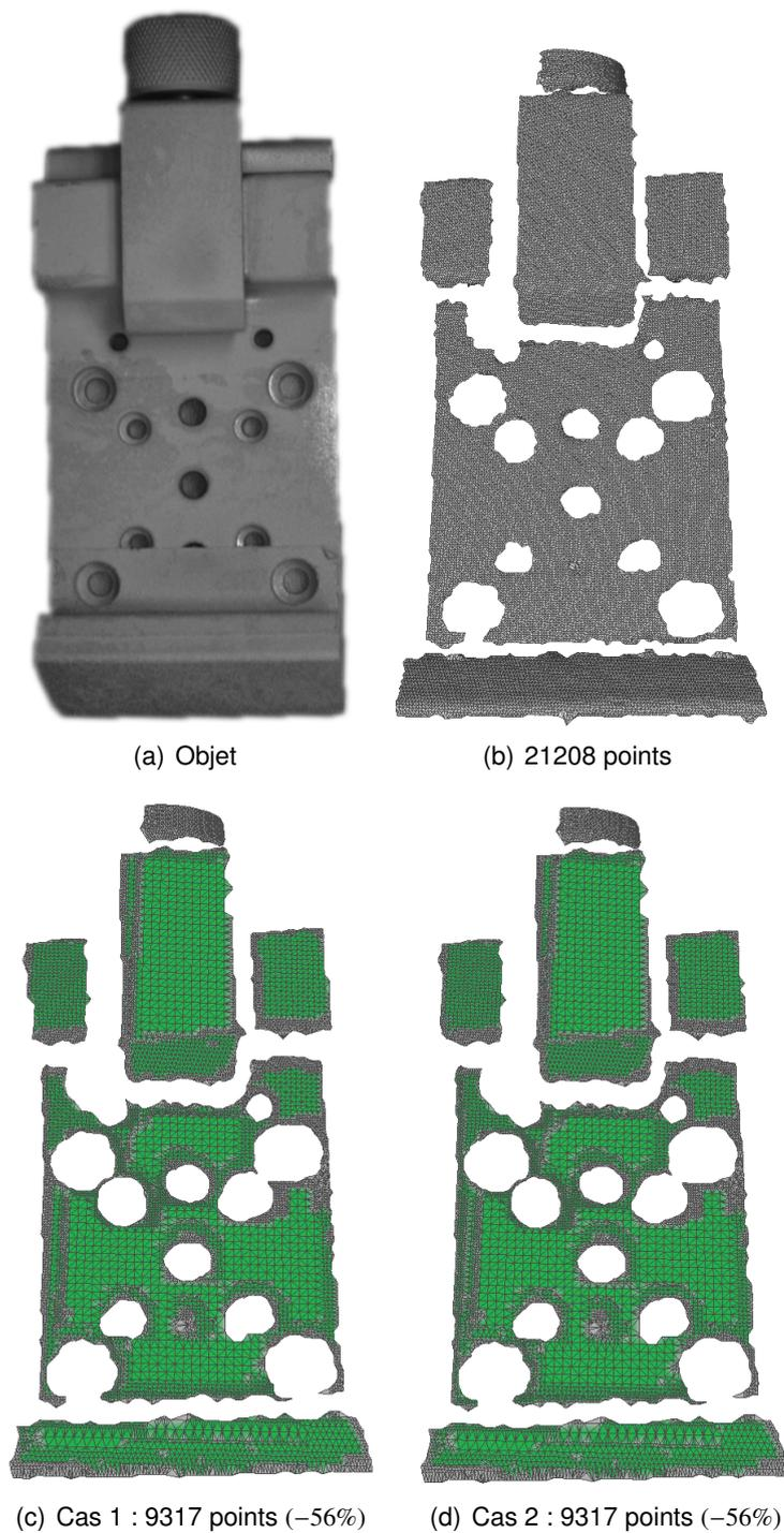
FIGURE 3 – Résultats sur une pièce manufacturée.
