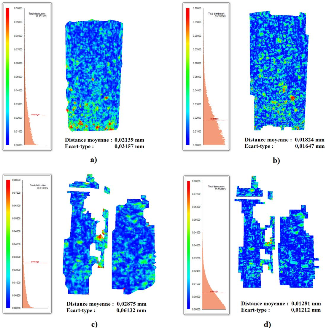
FIGURE 4.14 – Représentation de l'erreur entre un nuage de points dense et des surfaces paramétriques obtenues depuis un nuage de points de densité  $d = 1/5$ . a) Surface estimée sur un cylindre avec le logiciel RapidForm. b) Surface de Bézier avec prise en compte des normales sur le même cylindre. c) Surface RapidForm sur des objets non identifiés. d) Surface de Bézier sur ces mêmes objets.
