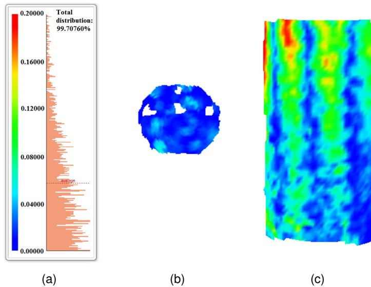
FIGURE 5.11 – *Distance entre la primitive ajustée et les points 3D pour les deux zones sélectionnées sur l'objet 1. a) Échelle des distances. b) Distance points/primitives pour la première zone (figure 5.7-b). c) Distance pour la deuxième zone (figure 5.7-c).*
