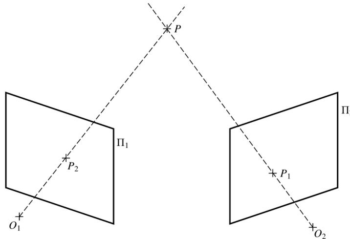
FIGURE 2.2 – Principe de la stéréovision.
