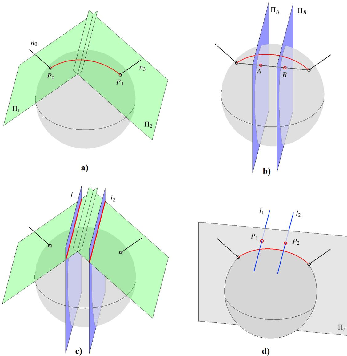
FIGURE 4.13 – Estimation des points de contrôle en 3D. a) Plans tangents à la surface aux points  $P_0$  et  $P_3$ . b) Plans orthogonaux ( $P_0, P_3$ ) et passant par les points  $A$  et  $B$ . c) Les intersections des plans forment deux lignes  $l_1$  et  $l_2$ . d) Les intersections des lignes avec le plan  $\Pi_r$  forment les points de contrôle  $P_1$  et  $P_2$ .
