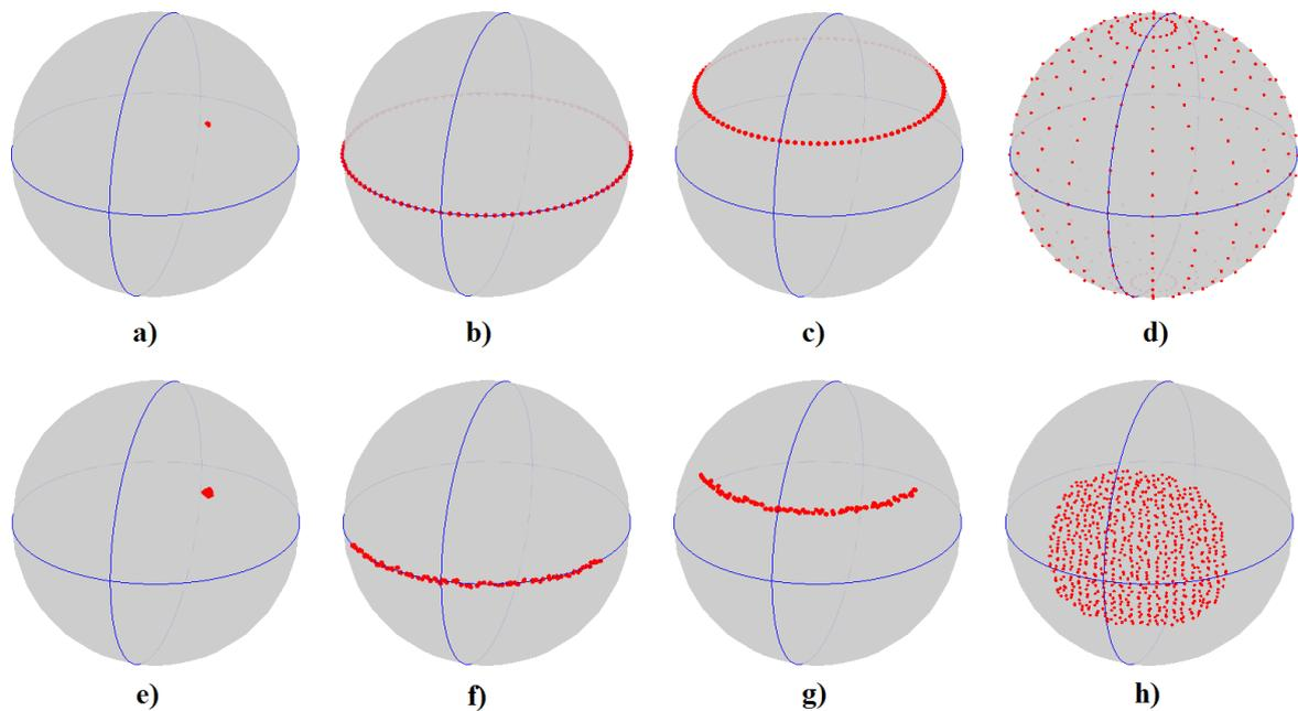
FIGURE 3.14 – *Représentation de différentes primitives géométriques sur la sphère gaussienne. a-d) Représentation théorique pour un plan, un cylindre, un cône puis une sphère. e-h) Représentation pratique pour les mêmes primitives avec notre système. La représentation est partielle car l'acquisition ne fournit qu'une portion de la primitive.*
