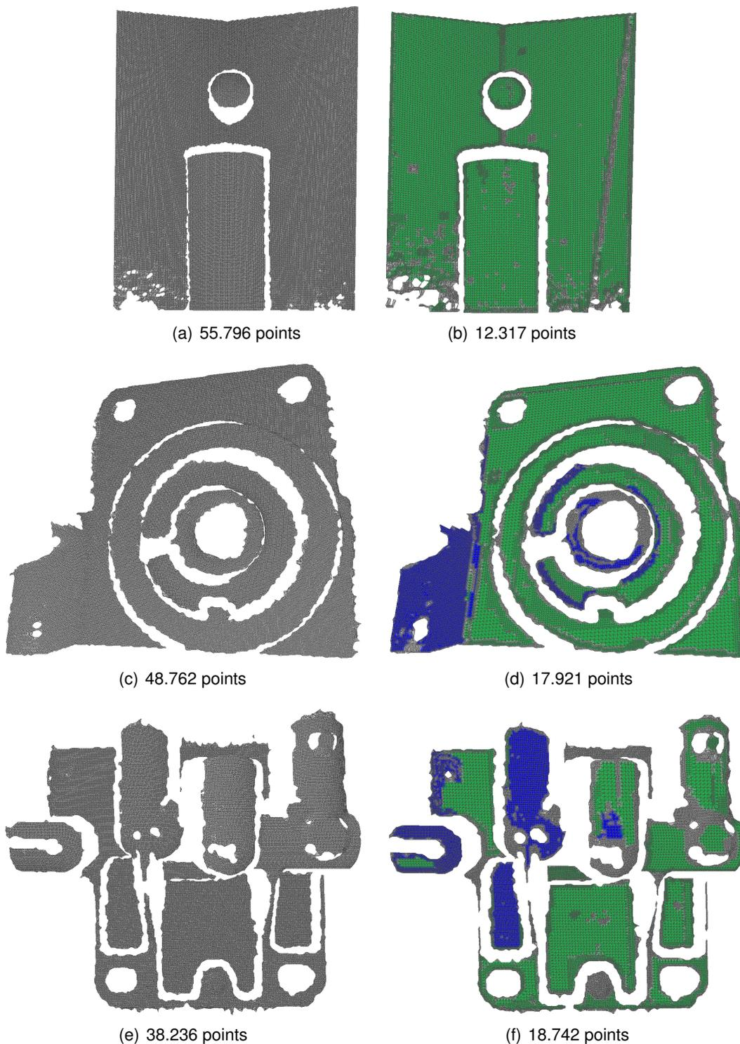
FIGURE 5.15 – Résultats finaux obtenus pour chaque objet. a), c) et e) Nuage de points maillé obtenu à la densité maximale  $d = 1/2$ . b), d) et f) Nuage de points maillé obtenu avec notre système. En vert on trouve les zones identifiées comme des primitives et en bleu les zones identifiées comme des surfaces paramétriques. Les zones grises correspondent aux points calculés pour  $d = d_f$  qui n'ont pas été identifiés par une primitive.
