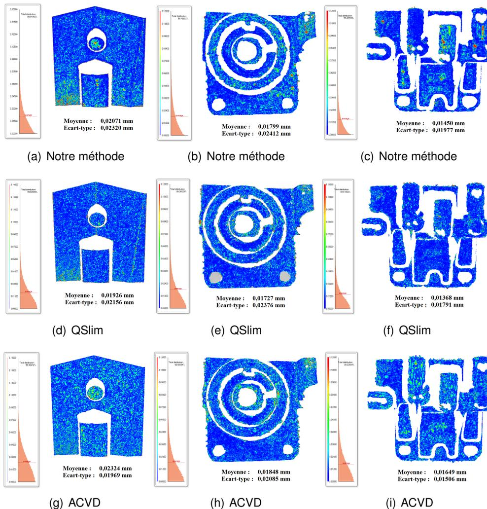
FIGURE 5.20 – Résultats obtenus par différentes méthodes de simplification.
