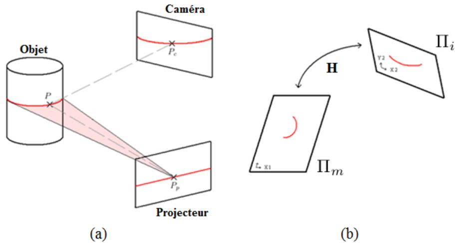
FIGURE 3.10 – Schématisation de la problématique. (a) Principe utilisé pour déterminer la courbure. (b) Relation entre le plan d'éclairage (demi-cercle) et le plan de la caméra (ellipse).
