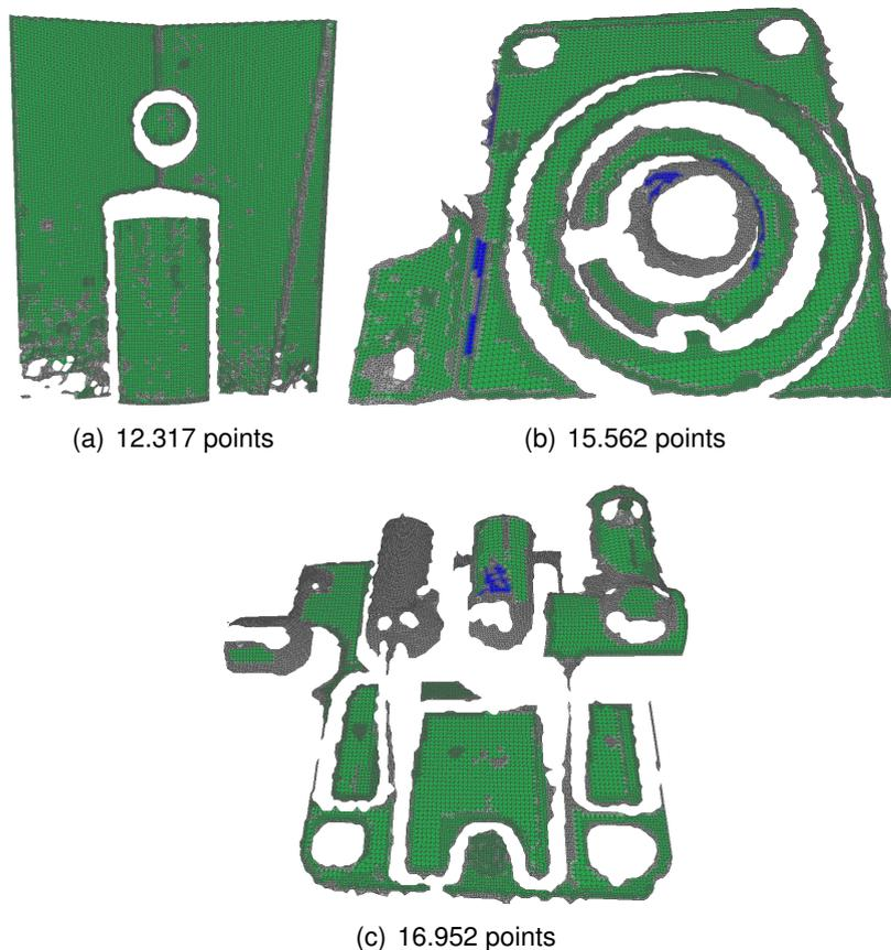
FIGURE 5.17 – Résultats obtenus sur chaque objet avec les paramètres du second cas. Distance moyenne  $\epsilon$  entre les données obtenues et les données denses. a)  $\epsilon = 0,01844$  mm. b)  $\epsilon = 0,02195$  mm. c)  $\epsilon = 0,02506$  mm.
