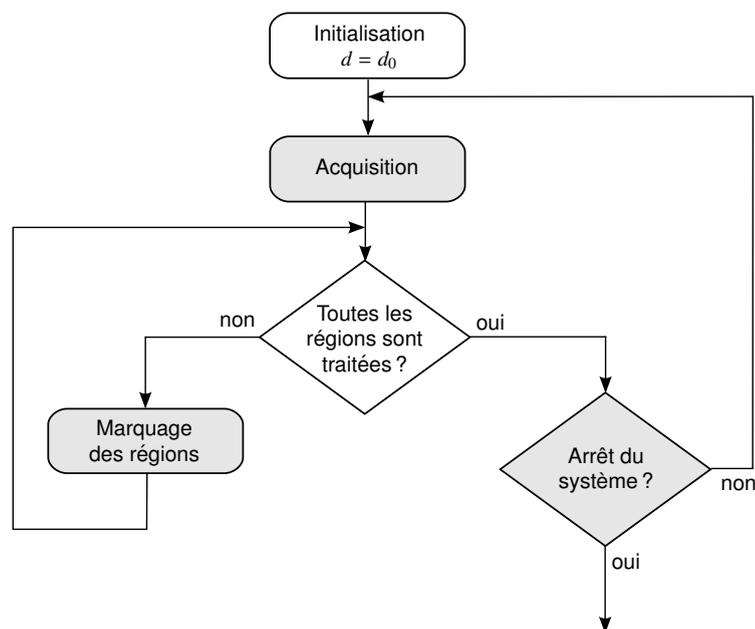
FIGURE 5.3 – Principe du système de numérisation dynamique.
