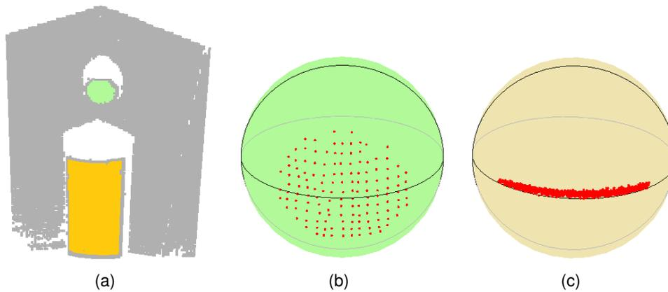
FIGURE 5.7 – Représentation sur la sphère gaussienne de deux zones segmentées (objet 1). a) Représentation 3D de deux zones segmentées. b) Représentation gaussienne de la zone verte. c) Représentation gaussienne de la zone orange.
