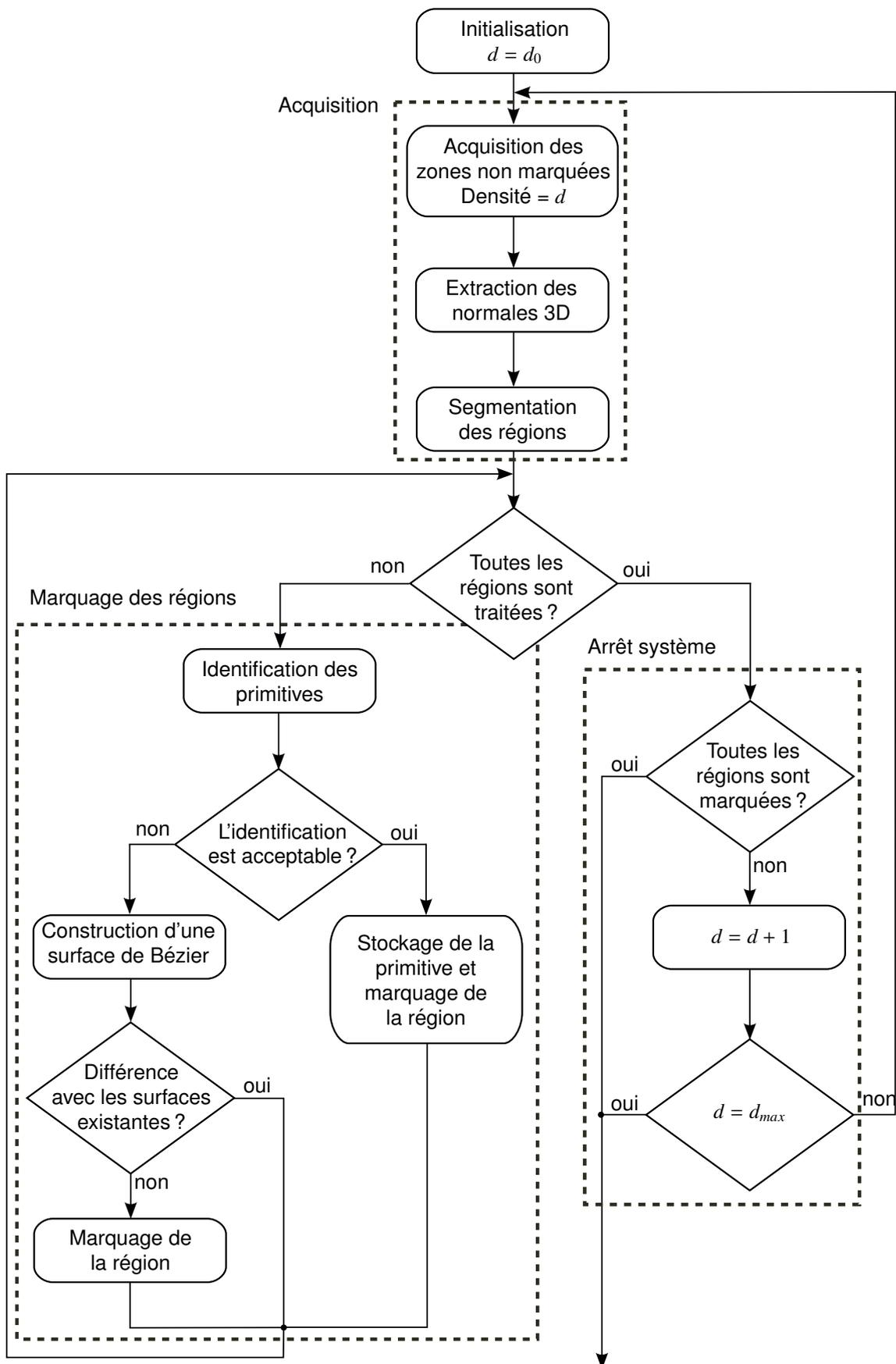
FIGURE 4.3 – Principe détaillé du système de numérisation dynamique.
