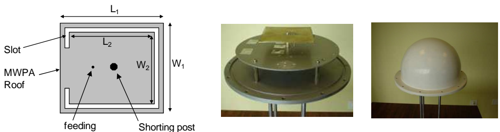
Figure II.1-7 : Antenne bi-bandes intégrée sur une balise ARGOS
