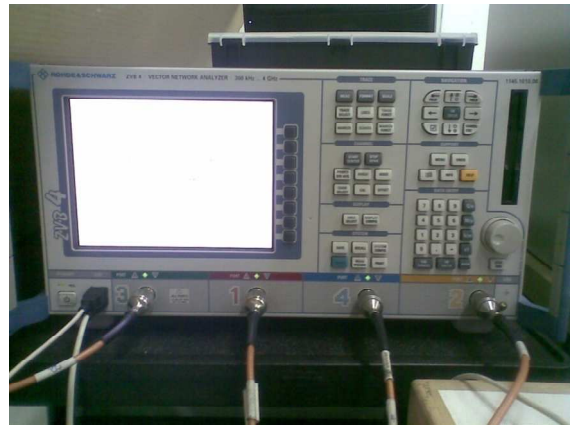
Figure II.5-5 : Antennes Vivaldi et analyseur 4 voies utilisés pour les validations expérimentales
