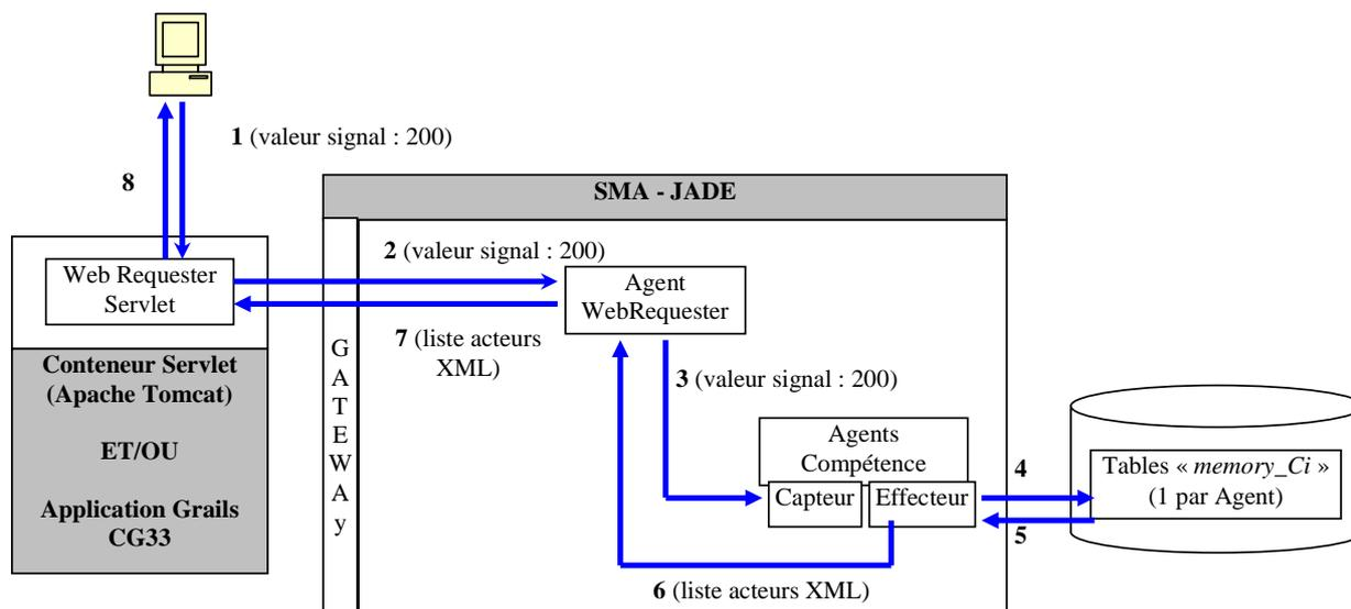
Figure 16 Sélection des acteurs : échanges de flux
