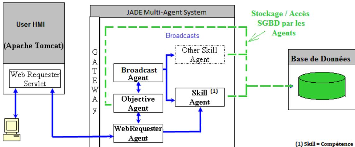
Figure 11 Echanges de flux dans notre SMA
