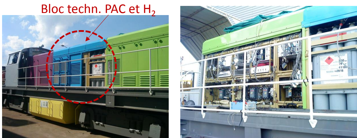
Fig. 2.60 : Bloc technique pile à combustible 80kW, stockage d'hydrogène et chargeur de batterie.
