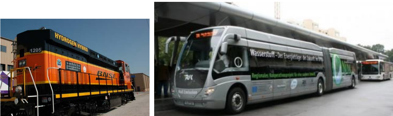
Fig. 2.28 : A gauche locomotive PAC hybride (Vehicle Projects Inc. et BNSF Topeka System, USA) à droite le bus articulé PAC hybride de 18 mètres "Phileas" (Allemagne).
