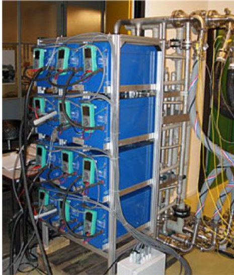
Fig. 2.31 : Système PAC PEMFC modulaire (50 à 120kW) de NedStack® (Pays-Bas).
