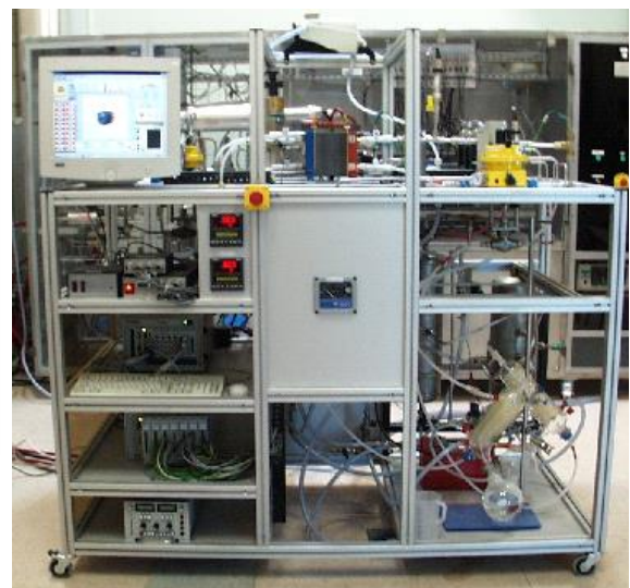
Fig. 2.12 : Banc bi-piles de 1kW au FCLAB
