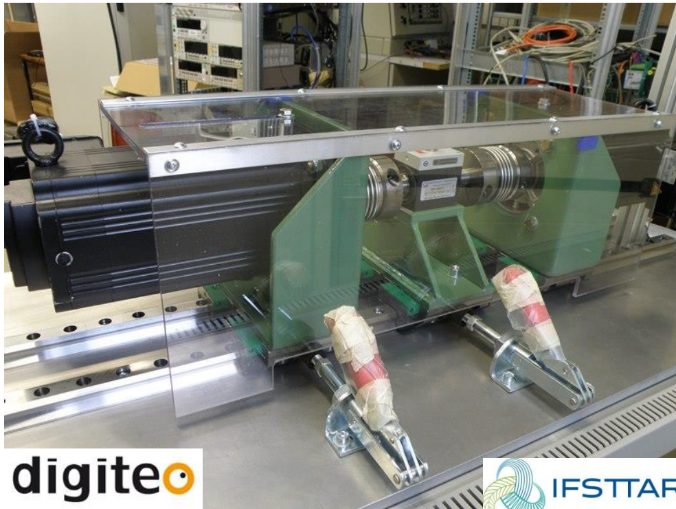
Fig. 3.15 : Photographie du banc mécatronique bimoteurs synchrone à aimants 17kW, 6000tr/mn (Financement par la fondation Digiteo DIM LSC dans le cadre du projet RÉGENEO).
