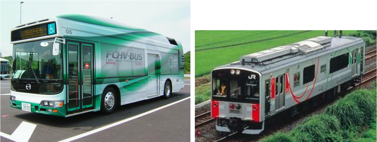
Fig. 2.27 : A gauche un minibus Toyota hybride à pile à combustible : Toyota FCHV-BUS (Japon) à droite le train Ki Ha hybride PAC/batteries du Railway Technical Research Institute (RTRI) and East Japan Railway Company (JR East) (Japon).
