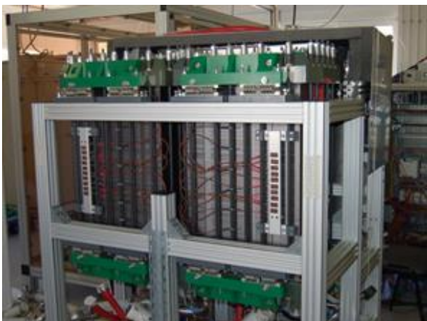
(c) Prototype PAC 80kW Helion (Areva) fournie pour les projets SPACT-80 et PLATHÉE
