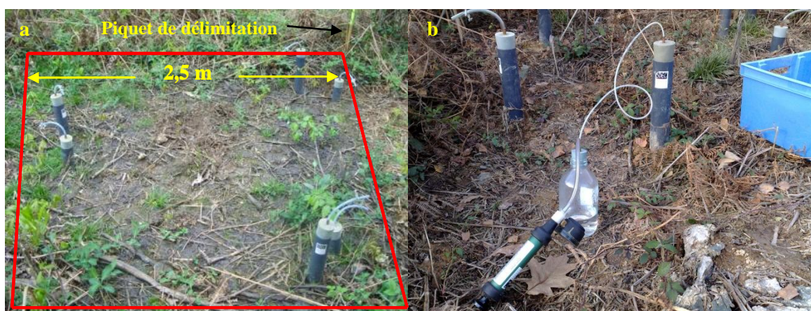
Figure 13 : a) Disposition des bougies poreuses dans une sous placette « B' » délimité par le carré rouge, b) Prélèvement de la solution du sol.
