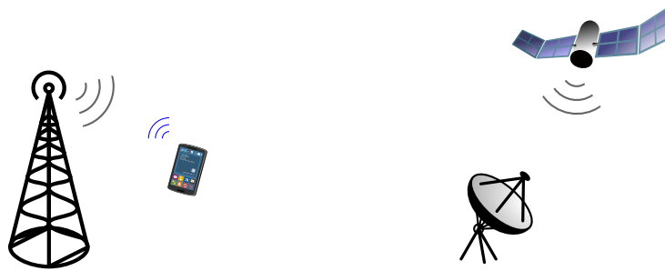
FIGURE 1 – Mise en évidence d'un système émetteur-récepteur (cas d'un système cellulaire, avec le lien mobile/station de base) et d'un système constitué uniquement d'un récepteur (antenne de réception satellite terrestre).
