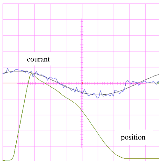
Figure A.19 Test dynamique, consigne sinusoïdale mesuré du courant du moteur (en bleu, 0.1 A d'amplitude) et la position du moteur d'entraînement en nombre de tours (en kaki, 5 tours par division), fréquence de 0,2 Hz
