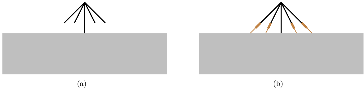
FIGURE 5 – Représentation d'une antenne parapluie idéale 5(a) et du modèle réel 5(b)
