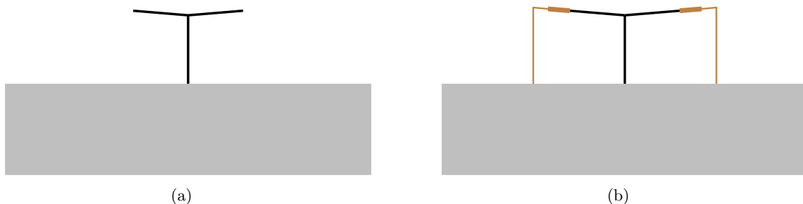
FIGURE 4 – Représentation d'une antenne en T idéale 4(a) et du modèle réel 4(b)
