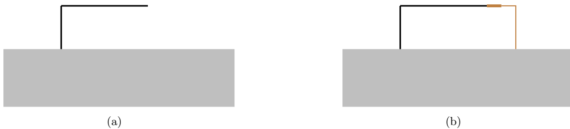
FIGURE 3 – Représentation d'une antenne en L inversé idéale 3(a) et du modèle réel 3(b).
