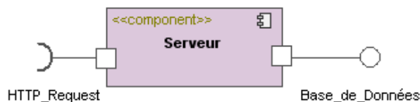
Figure 4.1- Représentation d'un composant doté de deux interfaces.
