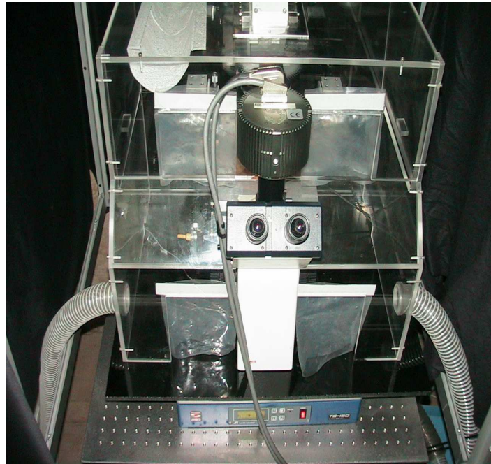
FIG. 1.12 – Une boîte en altuglass englobe la majeure partie du microscope. Les deux tuyaux sur le côtés sont en charge de la circulation d'air. La caméra CCD est placée sur la sortie photo du microscope. Le tout repose sur une table antivibration placée sur une table optique.
