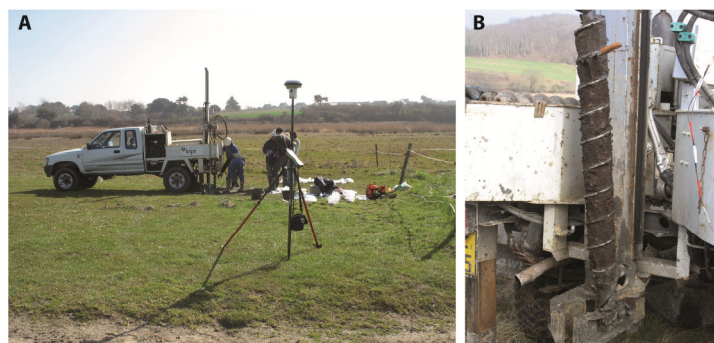
Fig.V.1.2 - Tarière à vis motorisée du BRGM.
