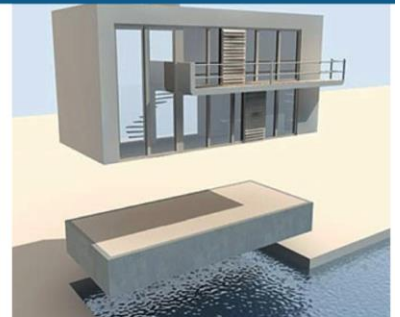
Figure 64 : maison sur un caisson flottant encastré dans la terre ferme. Source : inhabitat.com
