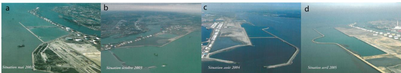
Photos 59 a, b, c et d : photos aériennes présentant l'évolution des travaux d'extension du port du Havre. Le phasage des travaux a été déterminé de façon à limiter les impacts environnementaux et respecter les mesures d'accompagnement préconisées. Source : Journal Flash Infos n°5, 2008
