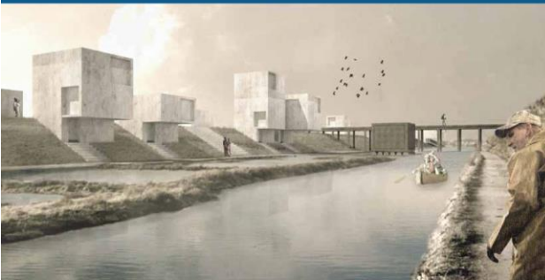
Figure 63 : maison intégrée à la digue de second rang et construite en «porte à faux». La vie de la maison est principalement située à l'étage. Source : Petit, 2013.
