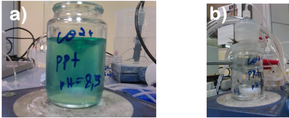
Figure 47 – Différence dans l'aspect visuel d'une solution contenant des précipités de \text{Co}(\text{OH})_2 avant (a) et après (b) sorption sur les feutres de carbone du type FNG.
