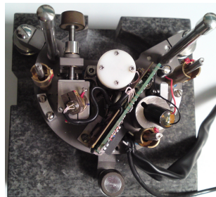
FIGURE C.3: Intérieur de la tête du microscope AFM
