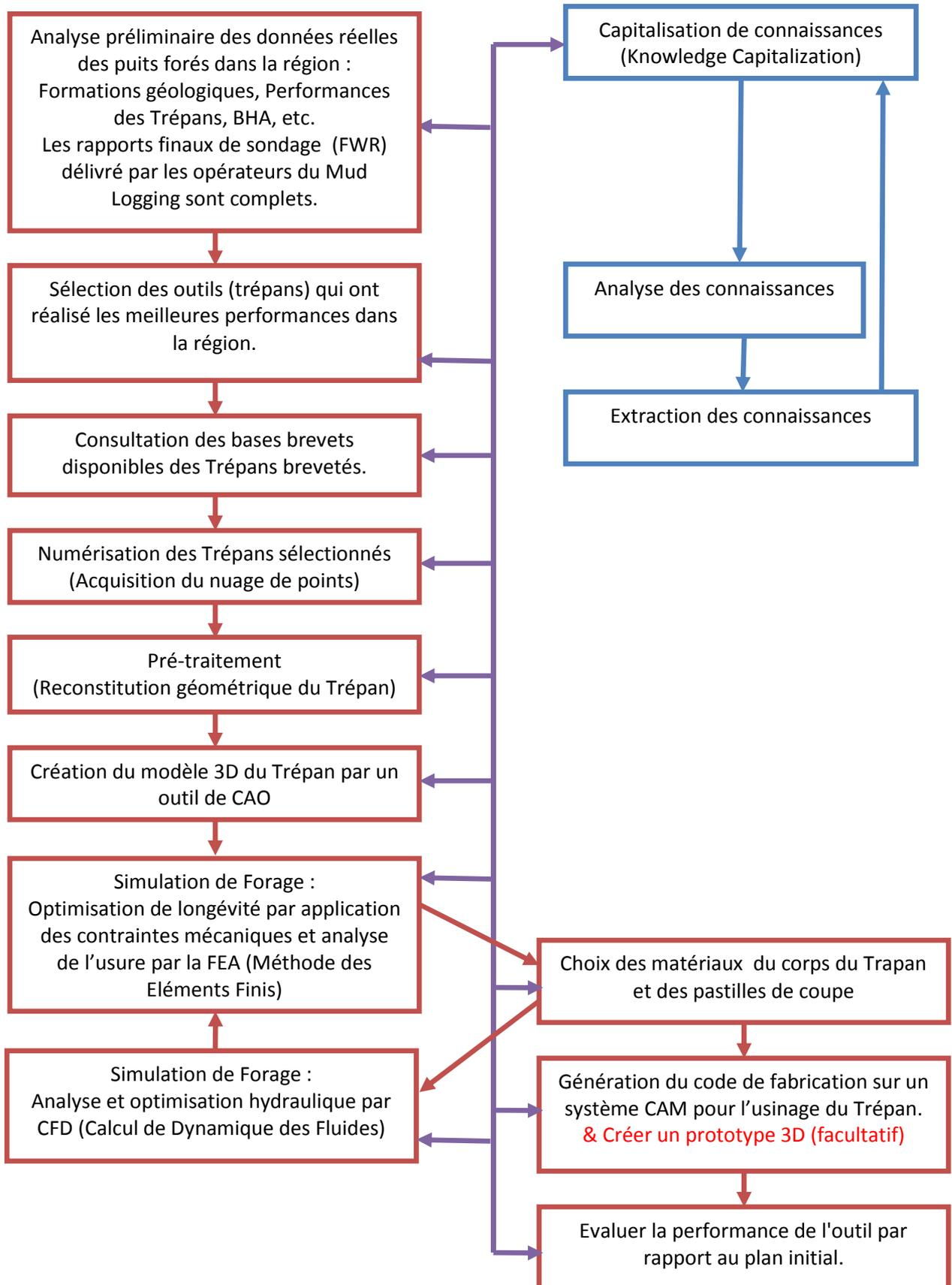
Fig. 8.15. Modèle spécifique du processus technique et cognitif pour la conception d'un Trapan par reverse engineering (Baaziz & al., 2014)
