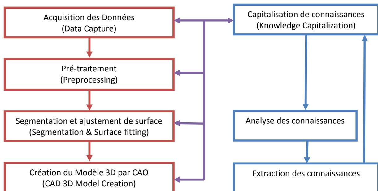
Fig. 9.14. Processus cognitif du reverse engineering des modèles solides, crée par Baaziz & al. (2014)
