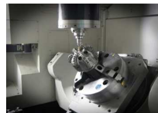
Fig. 9.13. Usinage d'un Trépan
