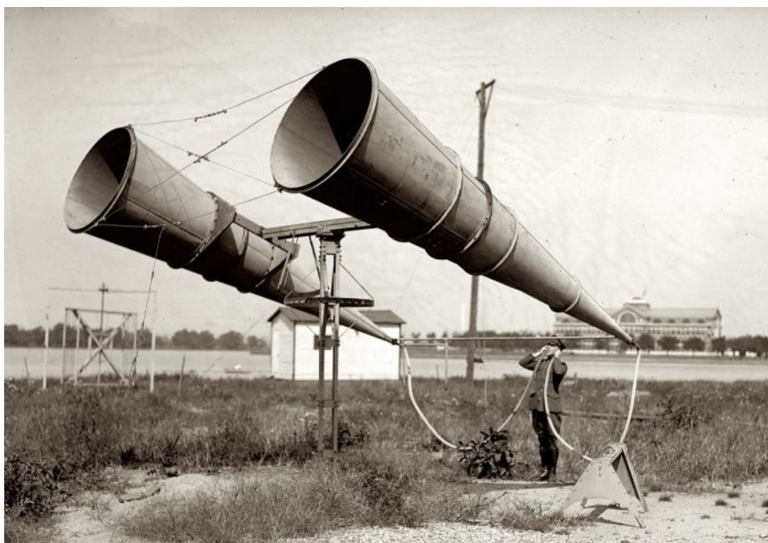
Figure I.6 : Radar acoustique bicône à Bolling Field, USA, 1921, d'après [museum of retro technology, 2009].
