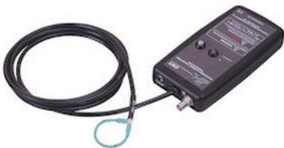
Figure 1.5: Photo d'une bobine de Rogowski fabriquée par Powertek [26]
