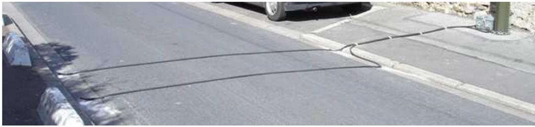
FIGURE 2.8 – Tuyau pneumatique (extrait de <http://www.iprocia.fr>).
