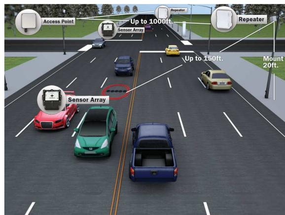
FIGURE 3.13 – Capteur magnétomètre (extrait de [www.sensynetworks.com](http://www.sensynetworks.com)).
