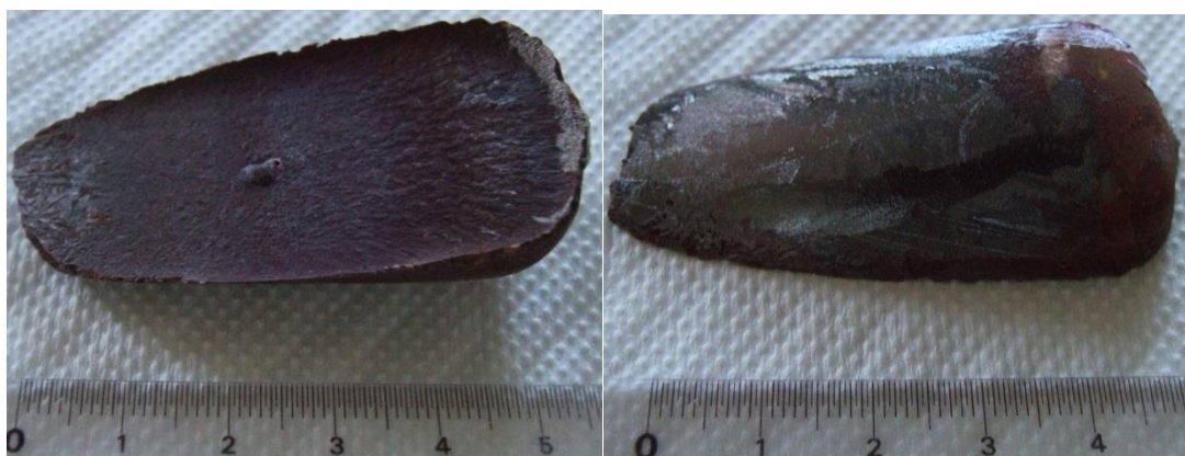
Figure 99: Photographies de l'échantillon I de synthèse avec une vitesse de refroidissement rapide non contrôlée.
