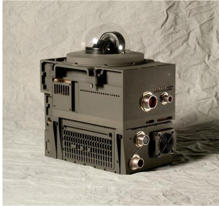
Figure 7: Système de contre-mesure CIRCUM de BAE Systems basé sur un cristal de ZnGeP_2 [14]
