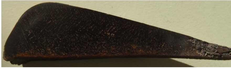
Figure 100: Photographie de la tranche de l'échantillon I avec une vitesse de refroidissement rapide non contrôlée
