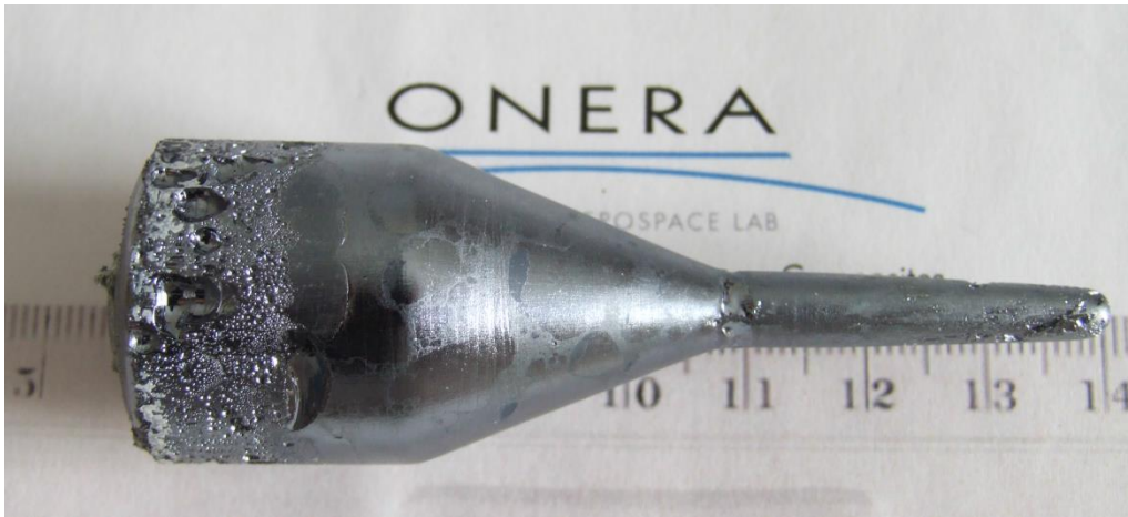
Figure 35: Photographie d'un cristal de ZnGeP_2 élaboré à l'Onera
