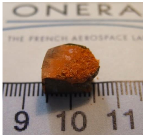
Figure 140: Photographie de l'échantillon de ZGSe après l'essai de recristallisation
