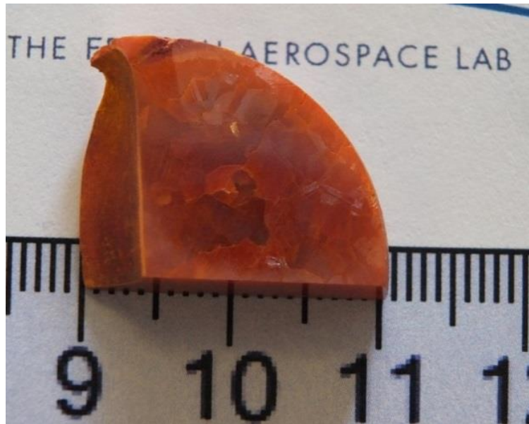
Figure 116: photographie de l'échantillon polycristallin extrait de la partie II de ZGSe pur du lingot III (montré en Figure 107 et Figure 112)
