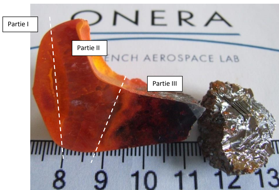
Figure 107: Photographie de la tranche de l'échantillon III, où trois zones sont observables (parties I, II et III).
