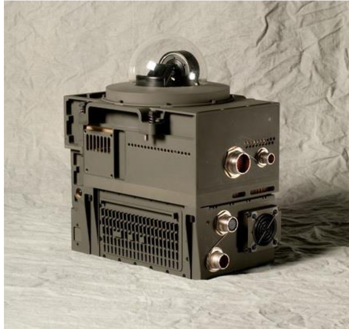
Figure 7: Système de contre-mesure CIRCM de BAE Systems basé sur un cristal de ZnGeP_2 [14]
