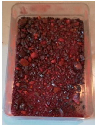
Figure 122: Poudre grossière (issue du broyage d'échantillon de synthèse) utilisée pour la croissance Bridgman. La couleur rouge provient de la phase à base de \text{Ga}_2\text{Se}_3
