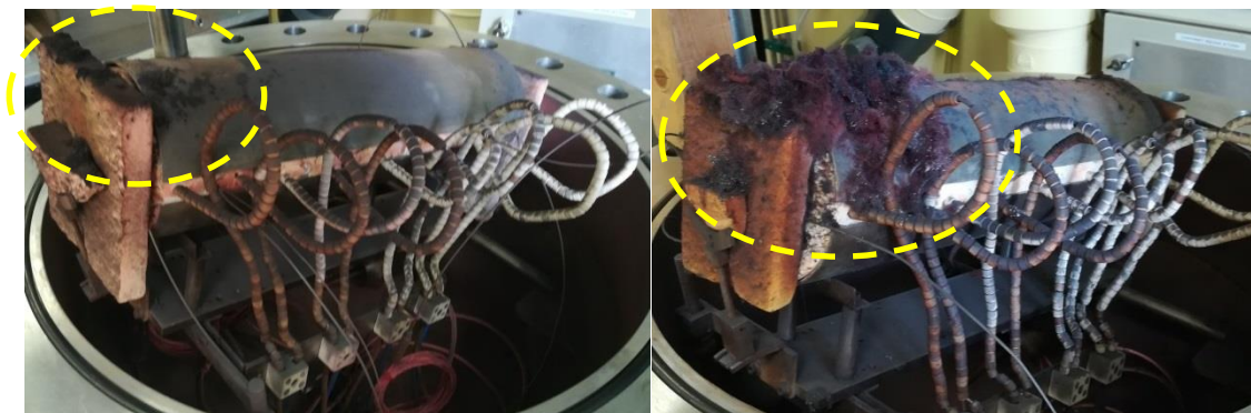
Figure 153: Photographies du four de synthèse après explosion d'une ampoule. Les amas violets (dans les cercles jaunes) correspondent aux composés s'étant condensés sur la paroi supérieure de l'autoclave de protection et étant retombés sous forme fibreuses.
