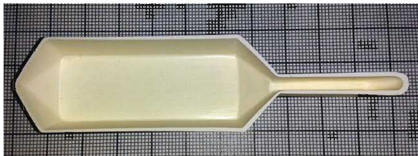
FIGURE 2.29 – Photographie d'un creuset utilisé pour la croissance cristalline en configuration Bridgman horizontale.
