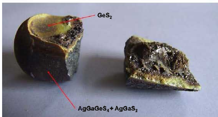
FIGURE 2.13 – Photographie d'un lingot obtenu à l'issue des synthèses effectuées dans la partie 2.1.5.1.
