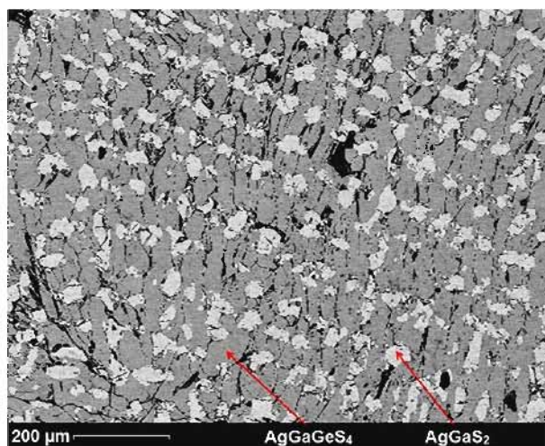
FIGURE 2.8 – Cliché de MEB réalisé sur une coupe du lingot, les phases AgGaGeS 4 et AgGaS 2 ont été identifiées par analyses EDS ; Composition globale AgGaS 2 :GeS 2 (53:47) d'après analyses EDS.
