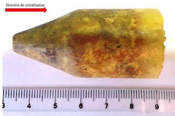
FIGURE 2.27 – Lingot obtenu après croissance cristalline avec rapport V_{amp}/m_{réactifs} optimisé.
