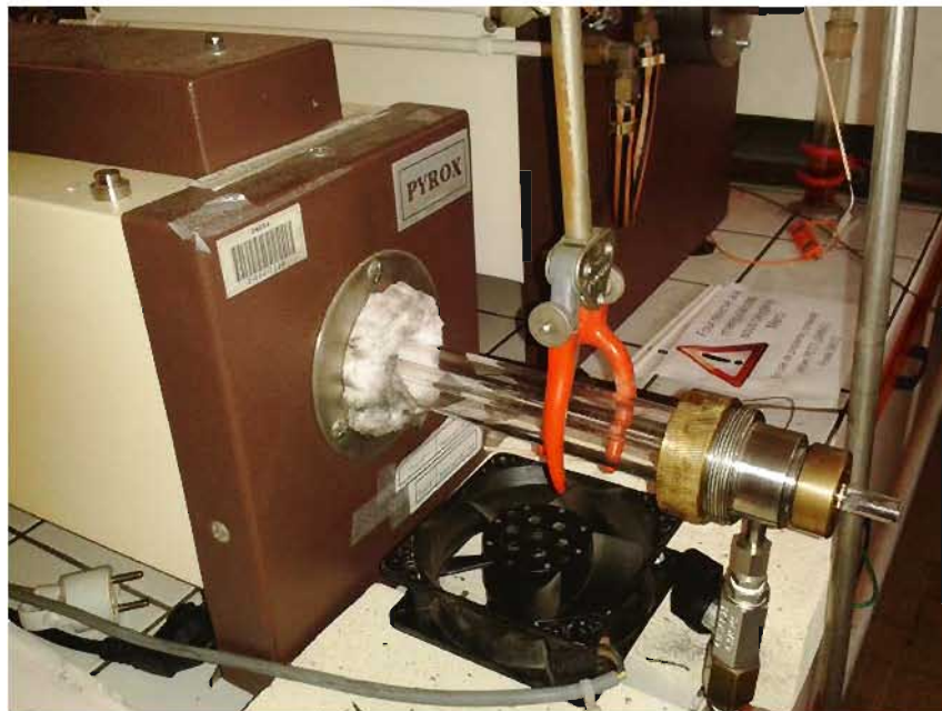
FIGURE 2.43 – Photographie du four utilisé pour les traitements de recuits.
