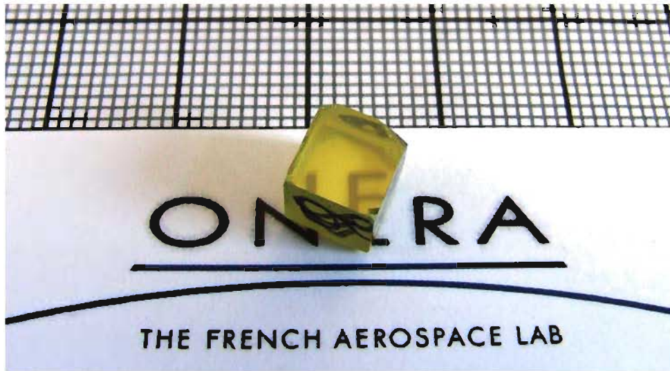
FIGURE 2.53 – Photographie d'un échantillon d'AGGS recuits, polis et orientés pour applications laser extrait du cristal préparé dans la partie 2.2.3.7.
