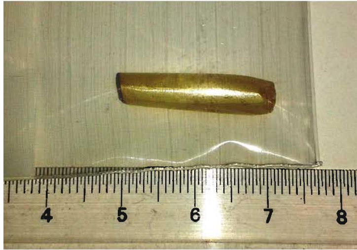
FIGURE 2.36 – Germe monocristallin (non orienté) taillé dans un grain issu d'un lingot d'AgGaGeS 4 obtenu après l'étape de synthèse.
