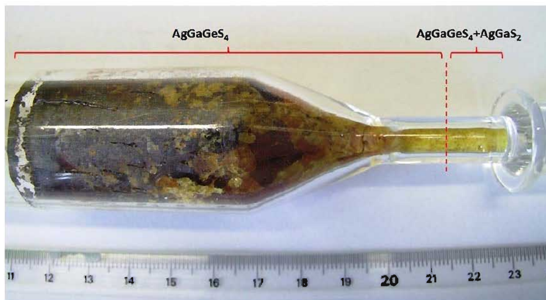
FIGURE 2.48 – Photographie de l'ampoule après croissance cristalline réalisée à partir d'un mélange stœchiométrique de polycristaux (Partie 2.2.3.9).
