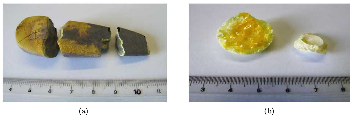
FIGURE 2.6 – Photographies d'un des lingots (a) obtenu à l'issue des premières synthèses et des produits condensés dans les parties haute et basse de l'ampoule (b).
