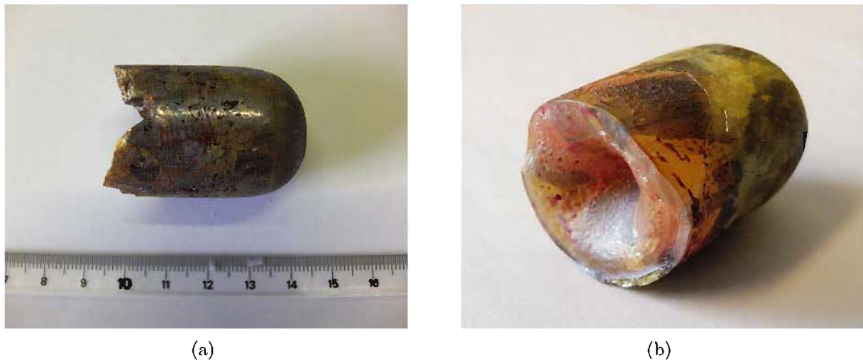
FIGURE 2.20 – Photographies des lingots obtenus à l'issue des synthèses effectuées en proportions 48:52 (a) et 50:50 (b) (AgGaS 2 :GeS 2 ).
