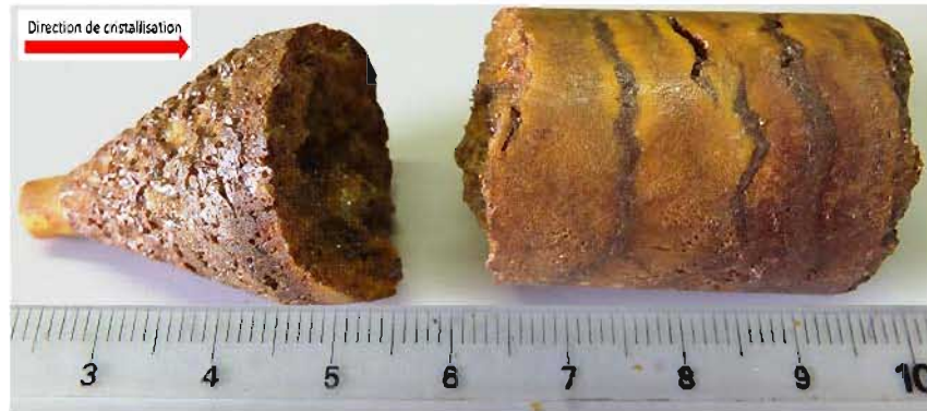
FIGURE 2.28 – Photographie d'un lingot obtenu après croissance cristalline réalisée sous pression d'argon (0,7 bar).
