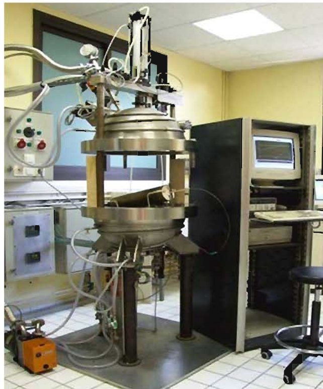
FIGURE 2.3 – Photographie du four de synthèse confiné dans un autoclave en inox.
