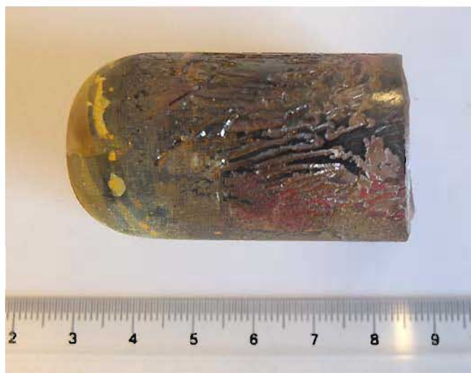
FIGURE 2.18 – Lingot polycristallin d'AgGaGeS 4 obtenu après synthèse chimique sans creuset.
