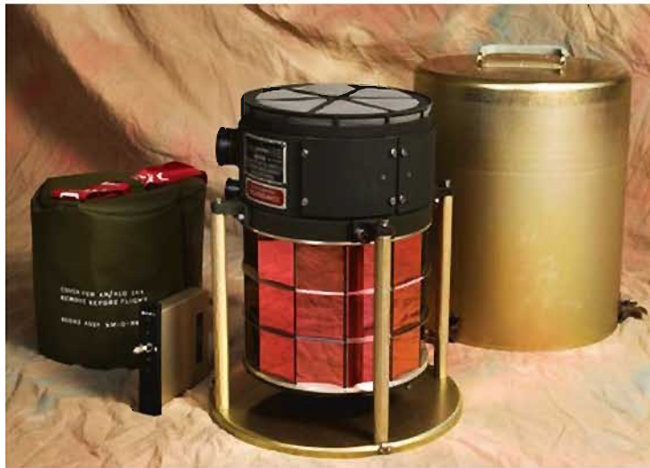
FIGURE 1.4 – Système de contre-mesures AN/ALQ-144 de BAE Systems [24].
