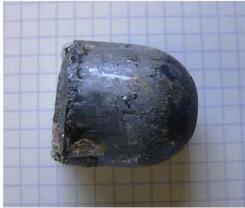
FIGURE 3.31 – Photographie d'un lingot polycristallin de ZnGeP_2:Sn obtenu après synthèse chimique.
