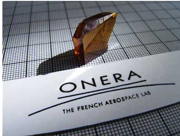
FIGURE 2.40 – Monocristal d'AgGaGeS 4 taillé et poli issu du lingot brut de croissance présenté sur la Figure 2.37.
