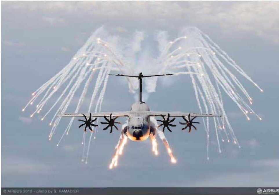
FIGURE 1.2 – Photographie d'un A400M libérant des leures conçus pour tromper les missiles anti-aériens à tête chercheuse thermique (en particulier les missiles sol-air) [21].
