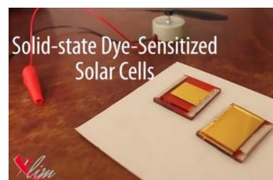
Figure 31 – Démonstrateurs XLIM ssDSSC (surface active 4 cm<sup>2</sup>)
