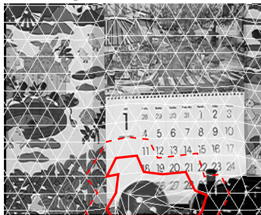
c. Zone d'occlusion: mailles dégénérées + dilatation de la zone avec un k -disk
