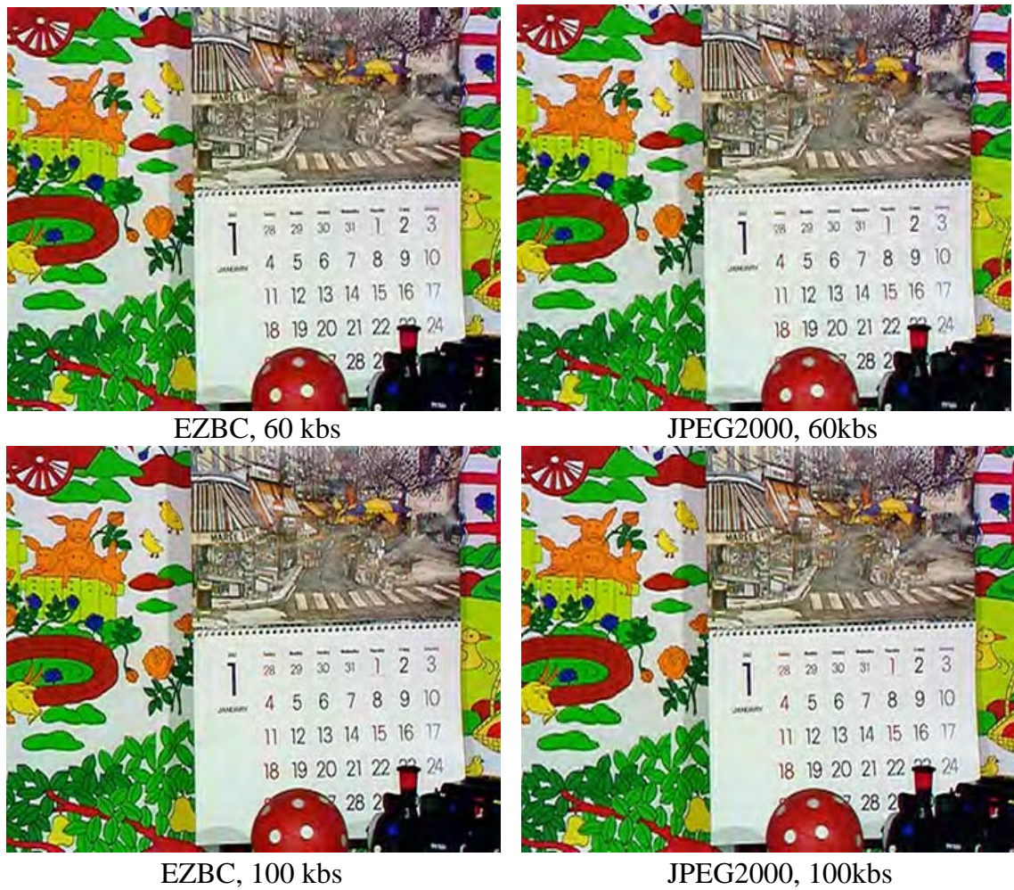
FIG. 2.22 – Comparaison EZBC et JPEG200 sur la première image de la séquence Mobile&Calendar , CIF
