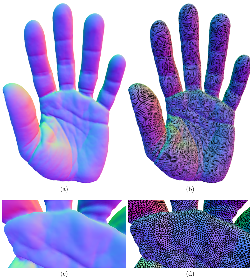
FIGURE 2.5 – Création d'un graphe à partir d'un modèle triangulaire 3D en utilisant l'algorithme de rendu de [Bærentzen et al., 2006]. (a) rendu du modèle, (b) graphe créé, (c) zoom sur le rendu du modèle, (d) zoom sur une partie du graphe créé.
