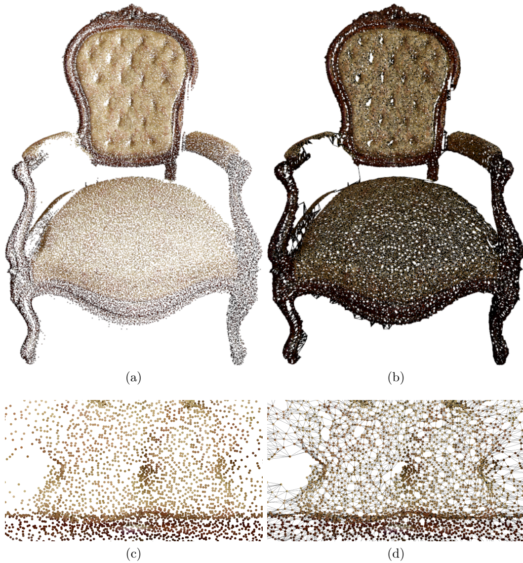
FIGURE 4.1 – Création d'un graphe à partir d'un nuage de points. (a) nuage de points d'origine, (b) graphe des 8 plus proches voisins, (c) zoom sur le nuage de points d'origine (d) zoom sur une partie du graphe créé.
