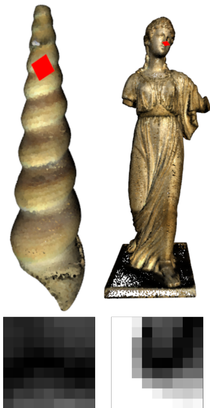
FIGURE 4.8 – Patch de hauteur sur des nuages de points (source http://viewshape.com ). La deuxième ligne représente le contenu des patches rouges contenus dans les nuages de points de la première ligne.
