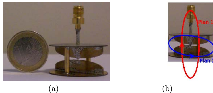
FIG. 3.13: Antenne monocône : photo (a), définitions des plans de mesure (b)
