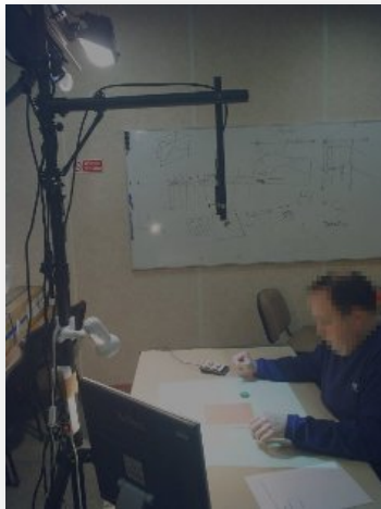
Figure 23. GeoTUI pendant une expérimentation à l'IFP Energie Nouvelle : trépied, caméra, pavé numérique, palet, etc.
