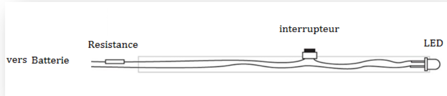
Figure 30. Schéma de conception du stylet
