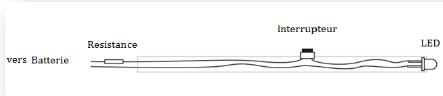
Figure 30. Schéma de conception du stylet
