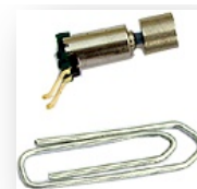
Figure 36. Moteur vibreur subminiature
