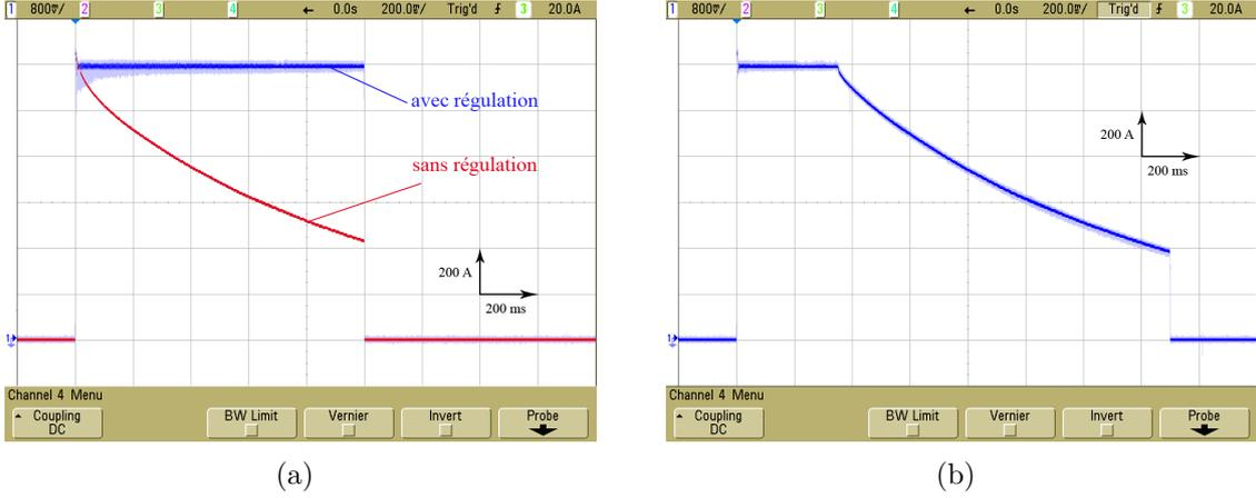
FIGURE 4.19: Génération des impulsions de courant de 1200 A : (a) cas où le courant est bien régulé et (b) cas où l'énergie des supercondensateurs n'est pas suffisante pour maintenir le courant à 1200 A.
