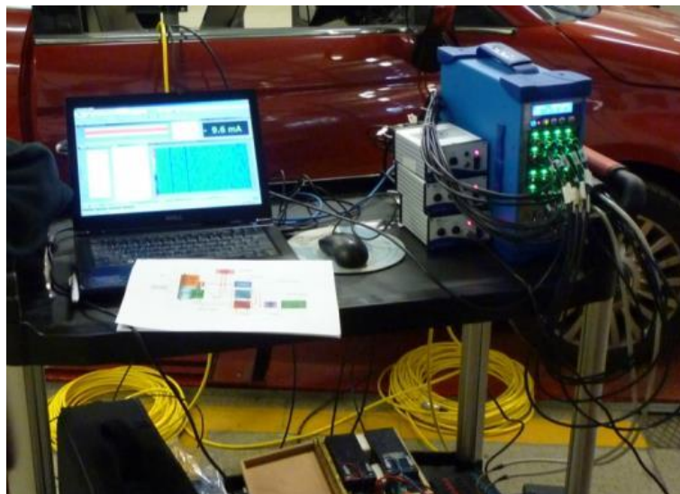
Figure I.1 : Centrale d'acquisition (à droite), ordinateur de contrôle et de visualisation (à gauche) et batterie d'alimentation des magnétomètres (en bas)
