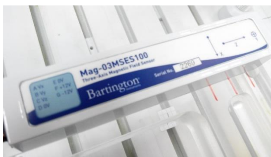
Figure V.2 : Magnétomètre Fluxgate (Mag-3MSES) « pour référence » et principales caractéristiques
