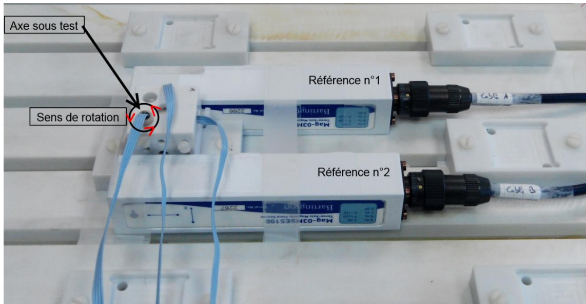
Figure V.8 : Configuration des capteurs pour l'évaluation de l'erreur d'alignement interne de l'axe de mesure
