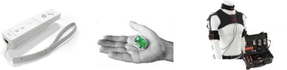
Figure 26 La capture inertielle. A gauche la Wiimote de Nintendo <sup>5</sup>, au milieu le MotionPod <sup>6</sup> de la société MOVEA, le MVN BIOMECH de Xsens <sup>7</sup>
