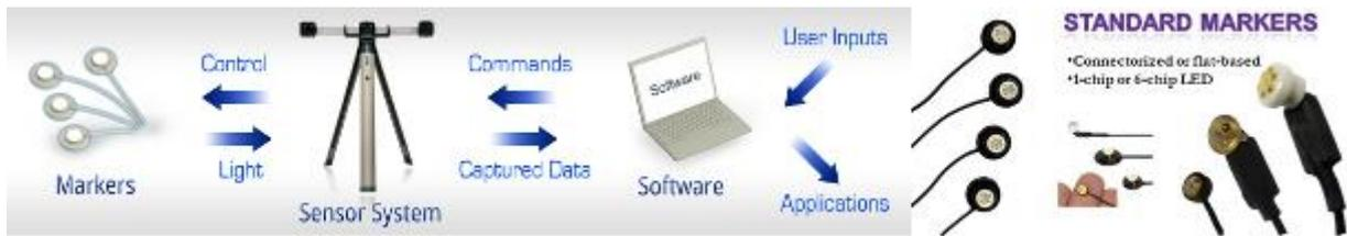
Figure 28 La capture optique avec marqueurs actifs par la société PTX (Phoenix Technologies Incorporated). A gauche le schéma de fonctionnement des systèmes, à droite des exemples de marqueurs photosensibles <sup>11</sup>
