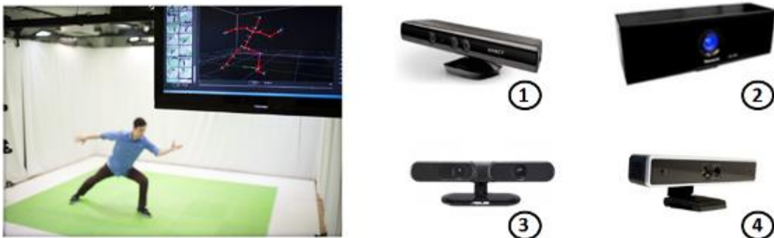
Figure 29 La capture optique sans marqueurs. A gauche, le réseau de caméras d'OrganicMotion, à droite des exemples de capteurs de profondeurs avec la Kinect de Microsoft en 1, D-Imager de Panasonic en 2, la Xtion de Asus en 3, DepthSense de SoftKinetic en 4.
