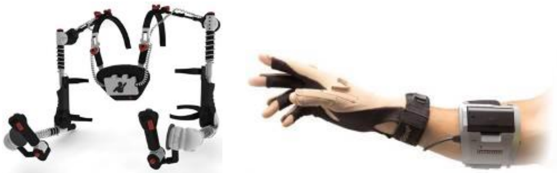
Figure 24 La capture électromécanique. A gauche le Gypsy de MetaMotion 1 , à droite le CyberGlove 2 de Immersion
