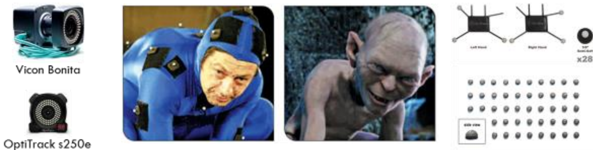
Figure 27 La capture optique avec marqueurs passifs. A gauche des exemples de caméras 8 , au milieu un exemple d'application pour la réalisation de film d'animation 9 , à droite des exemples de marqueurs 10
