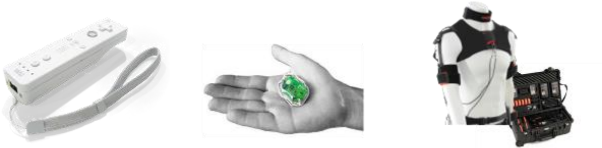
Figure 26 La capture inertielle. A gauche la Wiimote de Nintendo 5 , au milieu le MotionPod 6 de la société MOVEA, le MVN BIOMECH de Xsens 7
