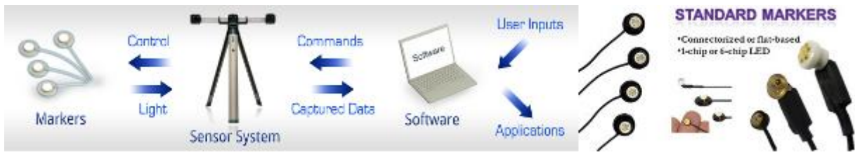
Figure 28 La capture optique avec marqueurs actifs par la société PTX (Phoenix Technologies Incorporated). A gauche le schéma de fonctionnement des systèmes, à droite des exemples de marqueurs photosensibles 11
