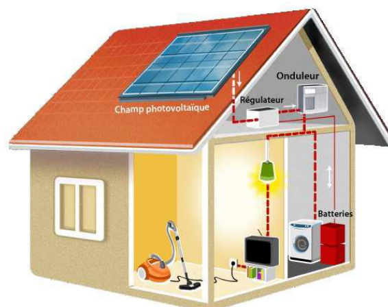
Fig. 1-7. Système photovoltaïque autonome [SYS-web1]
