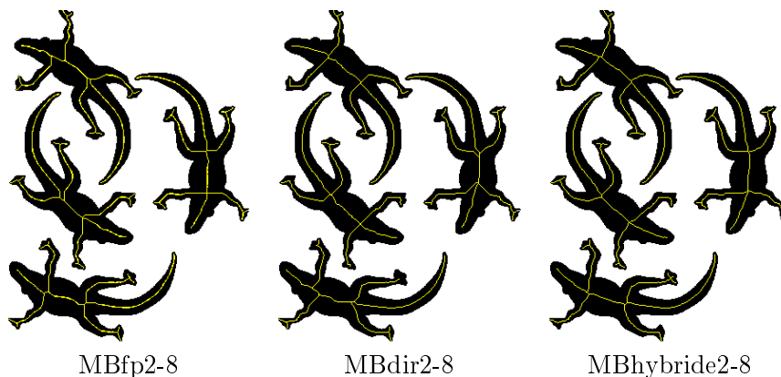
FIGURE 2.3 – La géométrie du squelette complètement parallèle (à droite) est fondée sur la distance de la 4-connexité, celle du squelette semi-parallèle (au milieu) sur la distance de la 8-connexité. Le squelette hybride (à droite) est plus invariant par rotation.
