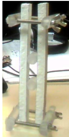
FIGURE 4.6: Montage de flexion, la distance entre les appuis extérieurs est de 150 mm, la distance entre les deux appuis centraux est de 40 mm. Les appuis sont des cylindres de diamètre 16 mm.
