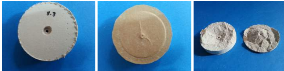
FIGURE 5.16: Echantillon après rupture en Nail Pull. (a) Face supérieure : l'échantillon a subi une forte compaction locale sous la tête du clou. (b) Face inférieure : la trace de la base du cône de fissuration est observée. (c) Faciès de rupture.
