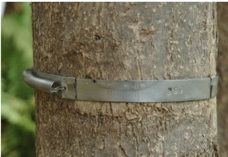
Figure 1.15 : Dendromètre ruban fixe à vernier placé sur un tronc à 1,30m du sol (Pélissier et al. 2011).
