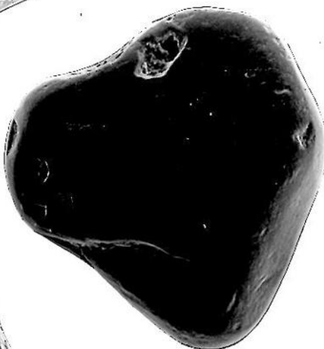
Grain bipyramidé, x100, lacunes de cristallisation et amorce de croissance.
