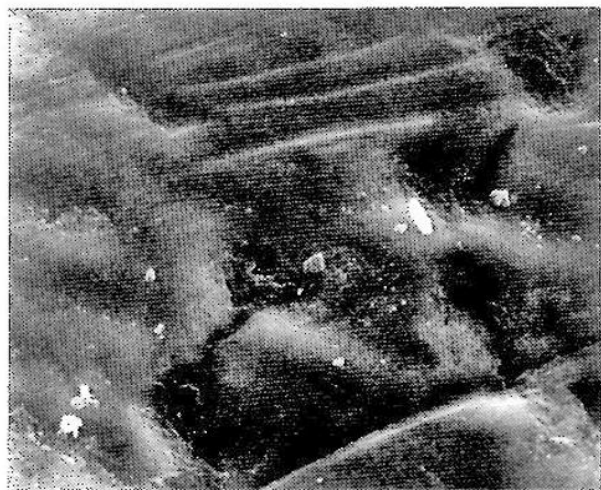
1 usure par friction
