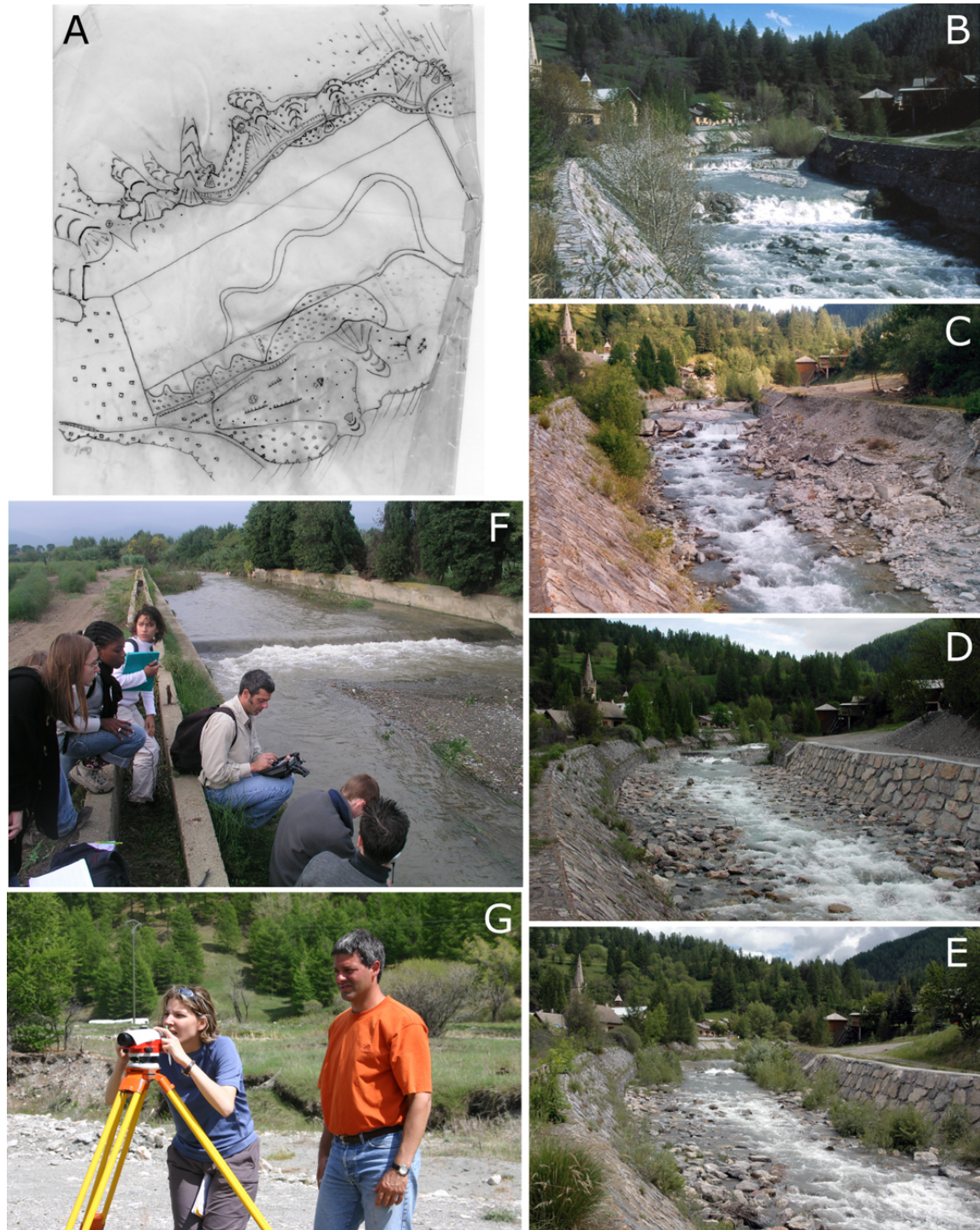
Figure 3.6 – Illustrations de quelques méthodes, techniques et outils utilisés pour l'acquisition des données de terrain (I: Cartographie géomorphologique de terrain, photographies au sol, relevés topographiques). A : Minute d'une carte de reconnaissance géomorphologique au 1/25.000 du marais d'Ancaõ et de ses bordures, Ria Formosa. B à E : Utilisation de la photographie diachronique dans l'étude des lits fluviaux, ici celui de l'Aigue-Agnelle, affluent du Haut-Guil, Queyras (B : cliché G. Arnaud-Fassetta, 1999 ; C : cliché M. Fort, 2001 ; D : cliché G. Arnaud-Fassetta, 2003 ; E : cliché G. Arnaud-Fassetta, 2007). F et G : Relevés topographiques [F : Mesure au DGPS de la largeur du lit de l'Argent-Double, affluent de l'Aude (cliché M. Fort, 2005) ; G : Visée au niveau dans la zone d'inondation du Haut-Guil (cliché M. Fort, 2005)].
