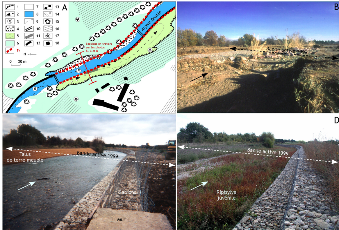
Figure 8.32 – Impacts hydromorphologiques et restauration du chenal de l'Argent-Double dans la plaine des Agals (Peyriac-Minervois amont). A : Impacts des aménagements hydrauliques sur la morphogénèse du lit lors de la crue de 1999. 1 = incision marquant la limite du chenal en crue ; 2 = direction du flux de crue ; 3 = phénomène de réflexion du flux de crue lié à la présence du mur bétonné ; 4 = banc graveleux ; 5 = épandage sableux ; 6 = plaine d'inondation ; 7 = zone exondée ; 8 = lit mineur ; 9 = limite du chenal après la crue ; 10 = seuil bétonné ; 11 = gabion (non détruit) ; 12 = mur bétonné (non détruit) ; 13 = mur basculé ou détruit ; 14 = enrochement détruit ; 15 = ripisylve ou haie ; 16 = vignoble ; 17 = vignoble arraché ou enseveli ; 18 = habitat ; 19 = future chenalisation (cf. photos B, C et D) [d'après Arnaud-Fassetta et al. , 2002, modifié]. B : Bande active de l'Argent-Double quelques semaines après la crue de 1999. Noter son élargissement bien au-delà des limites du chenal, dont la berge de RD est encore souligné par des gabions et des des enrochements (cliché G. Arnaud-Fassetta, 1999). C : Durant l'été 2002, le SIABAD fait procéder à des travaux de chenalisation et de restauration des berges, sans que la largeur du chenal ne soit augmentée : noter au premier plan le contact entre l'ancien mur et les nouveaux gabions (cliché A. et D. Baudouy, 2002). D : Un an après la chenalisation, le lit est déjà encombré par une ripisylve juvénile (cliché G. Arnaud-Fassetta, 2003).
