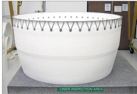
Figure 8 Tuyère de turboréacteur conçue par COI Ceramics pour Boeing Research & Technology [32].
