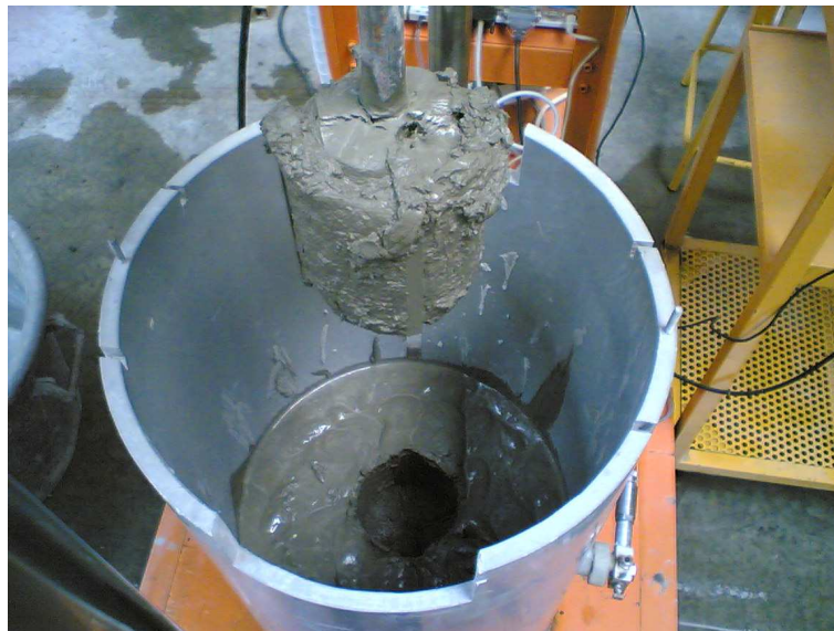
Figure II.3. Rupture pas cisaillement lors d'un essai au Vane test réalisé sur un béton ferme.
