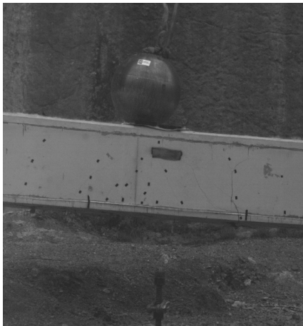
FIGURE 7.8 – Poutre au moment du dernier impact
