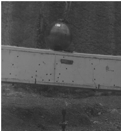
FIGURE 7.8 – Poutre au moment du dernier impact
