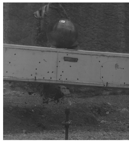
FIGURE 7.9 – Poutre 40 centièmes de secondes après le dernier impact
