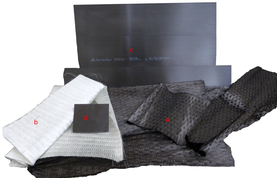
FIGURE 25 – a) Fibre de carbone tissé avant imprégnation - b) Fibre de verre avant imprégnation - c) Plaque en fibre de carbone unidirectionnelle Carbodur®- d) Fibre de carbone pré-imprégnée
