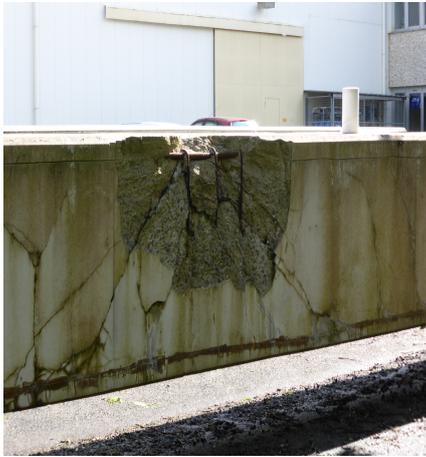
FIGURE 7.10 – Endommagement de la poutre après les différents impacts
